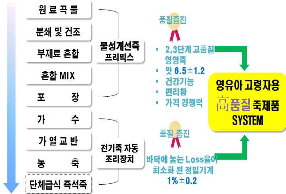
그림. 3-2 단체 급식용 죽 제품 제조 공정
