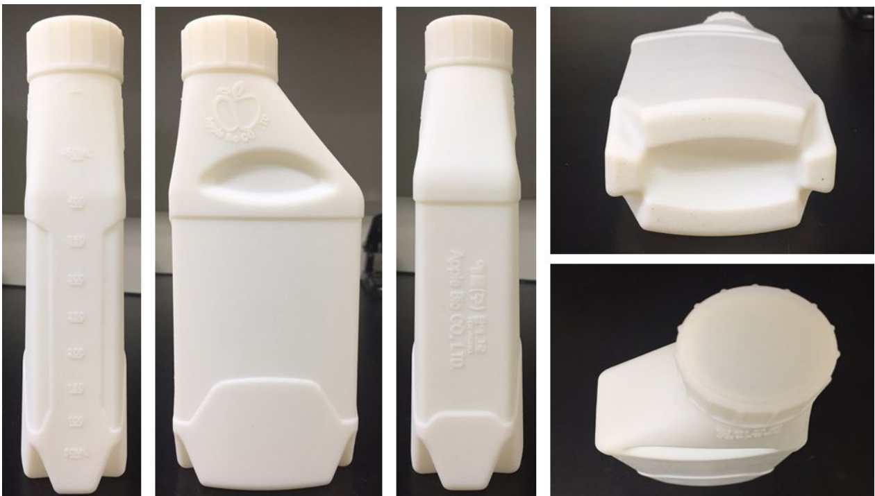
그림 13. 용액 안정화와 제품 차별화를 위한 제품 용기 도면 및 3D 프린트 사진.
