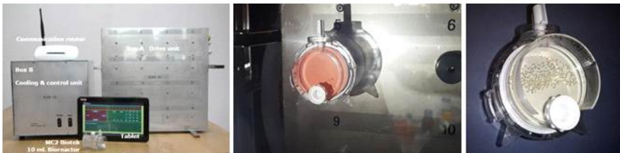
**그림 47. BAM(Bio Array Matrix) system과 3차원 배양중인 바이오리액터**
