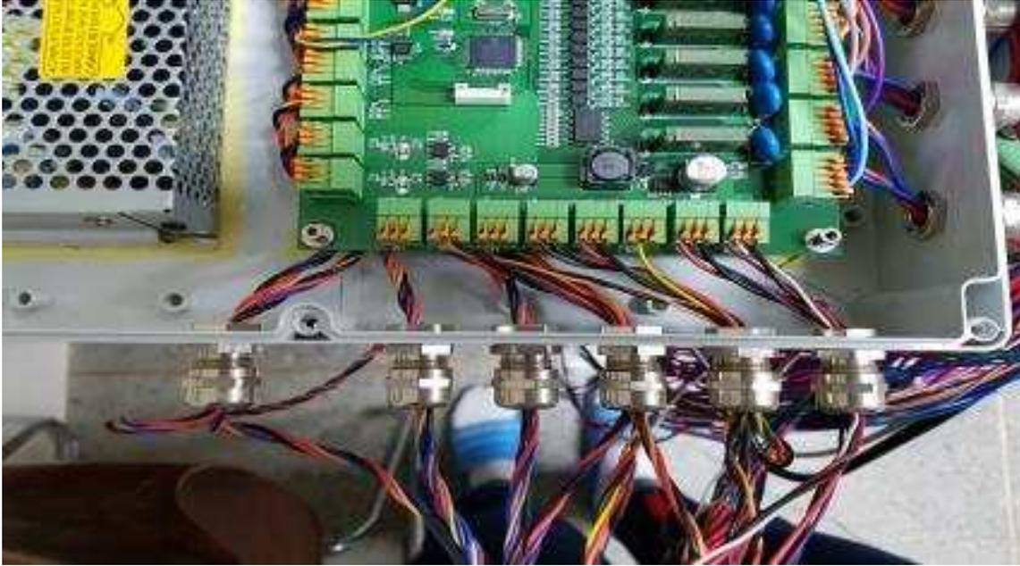
그림 3-1-34. 추가 단자를 설치하여 제어장비의 통제 범위를 높인 사진
