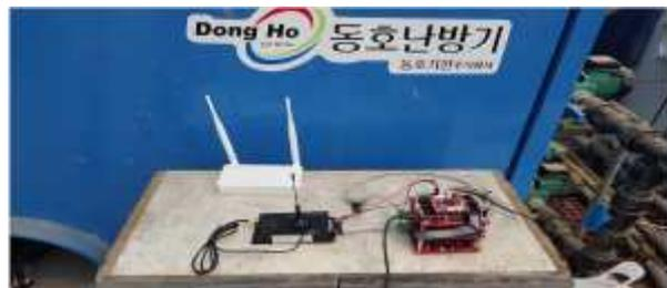
그림 3-2-59. 인터넷 접속과 CDMA 접속을 동시에 지원하는 시작기 현장 기본 성능 테스트
