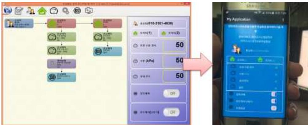
그림 3-2-76. 스마트폰을 이용한 원격 계측 및 제어 화면 테스트
