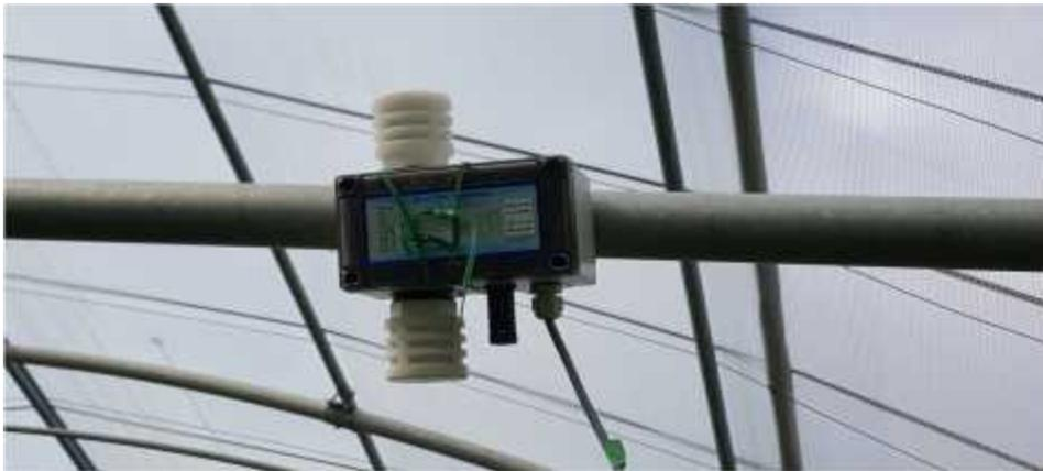
그림 3-4-4. 농가에 설치된 온도, 상대습도와 이산화탄소 센서 사진
