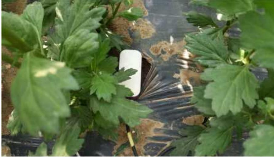
그림 3-4-3. 농가에 설치된 지온, 토양수분과 토양농도 센서 사진
