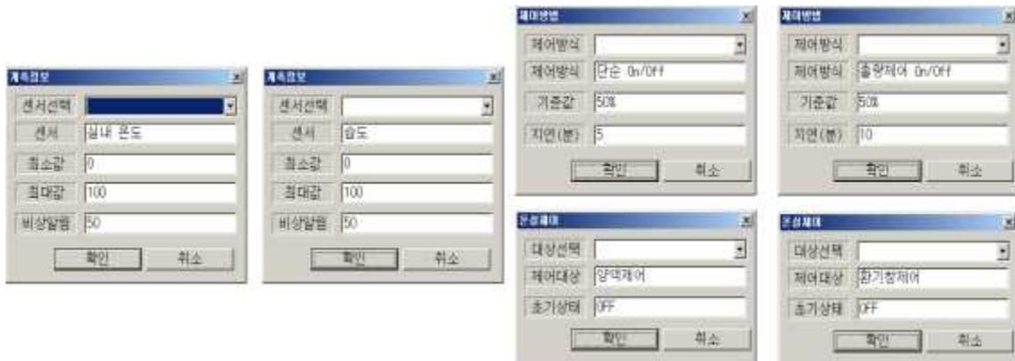
그림 3-2-64. 2차 실험 현장의 온실 환경 계측 및 제어 요소 환경 설정 예시
