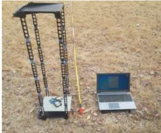
그림 3-2-5 거리, 높이에 따른 IEEE802.15.4 통신을 측정을 위한 실험 전개도(거리 10m ~ 60m)      그림 3-2-6. 실험장비 구성, 높이 조절장치 (왼쪽), 컴퓨터(오른쪽)
