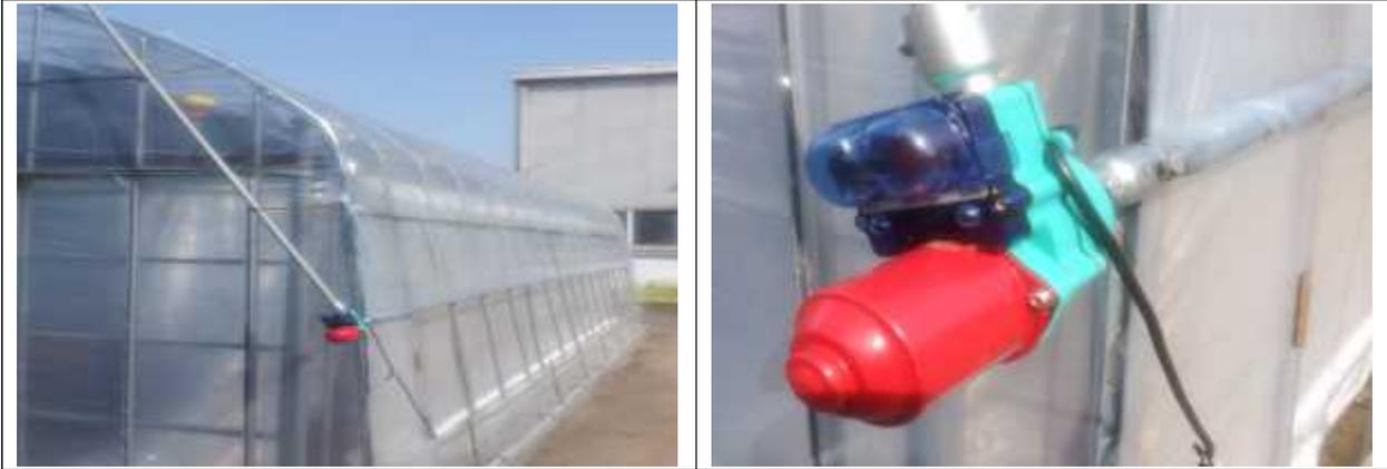
그림3- 5-17. 통제시스템을 확인하기 위해 시설 내부에 설치된 좌우 측창 좌우 개폐기
