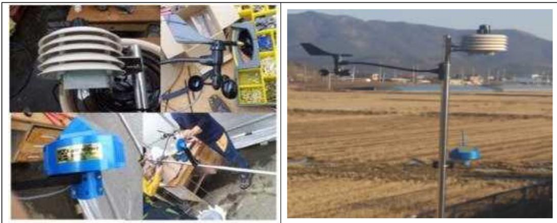
그림 3-5-20. 외부 환경상태를 확인 하기 위한 외부기상대 설치
