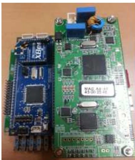
그림 3-2-19. Zigbee, Bluetooth, WiFi, PLC 통합모듈
