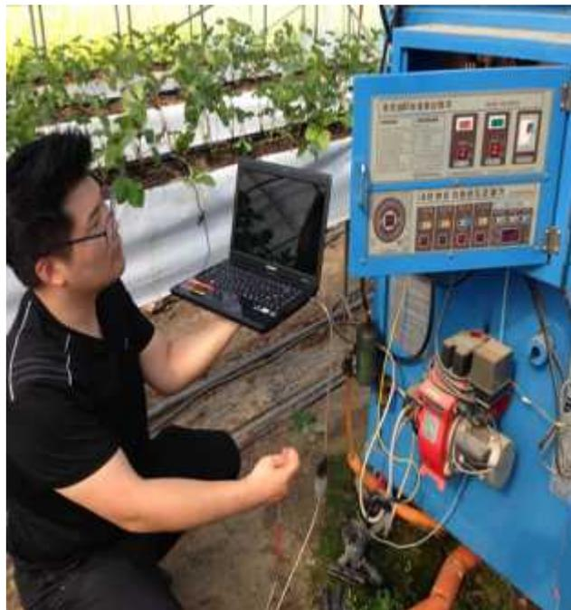
그림 3-1-26. 제작한 통제 장비를 이용하여 난방기 on/off 실험 사진
