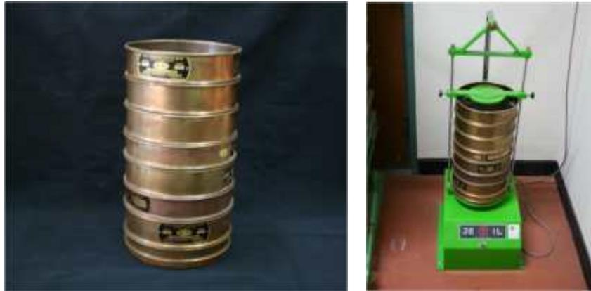
그림 3-3-15. 실험에 사용된 체(sieve)와 Ro-tap Sieve Shaker
