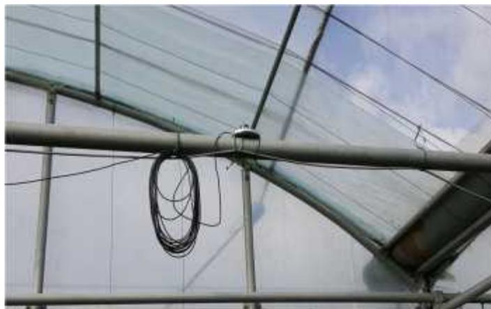
그림 3-4-2. 농가에 설치된 광 센서 사진
