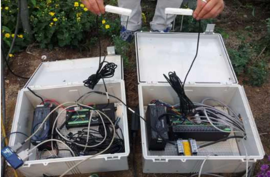
그림 3-1-29. 실험을 위한 장비 제어 모듈 박스 사진
