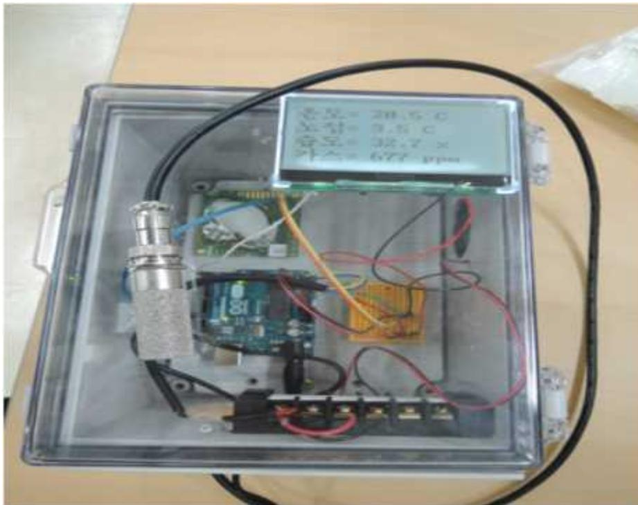
그림 3-4-7. 온실에 설치하기 위한 환경계측 모듈(온도, 노점온도, 상대습도와 이산화탄소농도 측정 가능)
