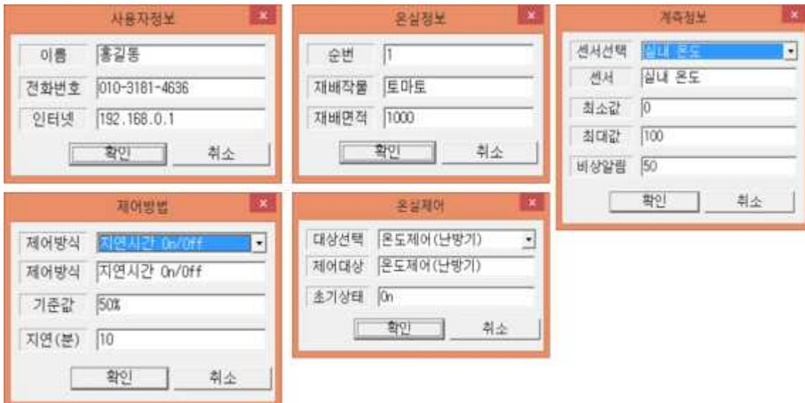
그림 3-2-73. 온실 환경 계측 및 제어 S/W 주요 요소의 사용자 설정 화면
