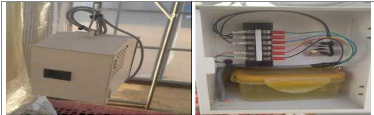
그림 3-5-21. 외부 하우징을 통해 간섭을 최소화 하여 제작한 내부온습도 센서
