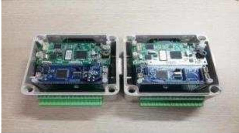
그림 3-1-20. 각 센서 모듈을 연속 연결한 사진
