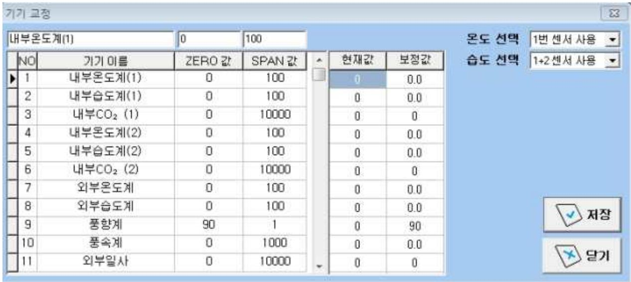
그림 3-5-52. 내부 장비 및 센서로 받는 데이터 값의 오류 발생 시 기기교정 화면
