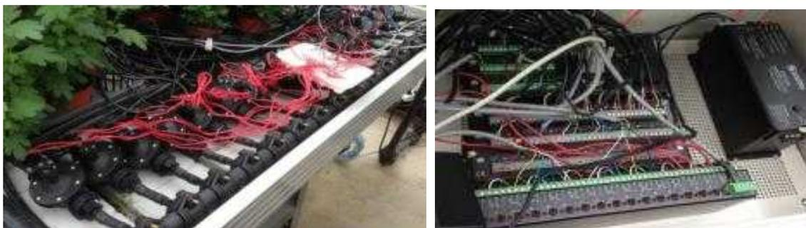
그림 3-3-30. VWC 4개 처리구와 4블록 실험을 위한 16 solenoid valve 및 데이터로거의 설치 모습
