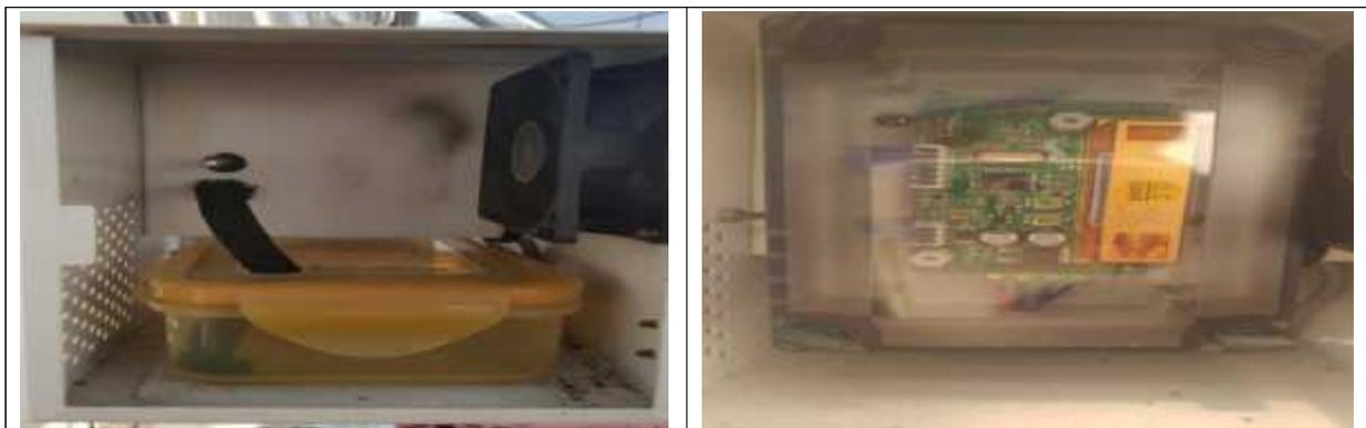
그림 3-5-22. 외부 하우징을 통해 간섭을 최소화 하여 제작한 CO<sub>2</sub>센서
