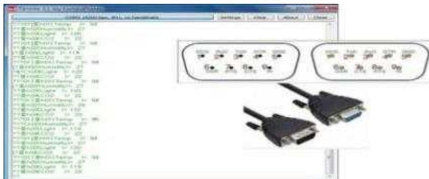
그림 3-1-9. Termit(S/W)와 RS-232 통신 케이블 사용하여 데이터를 받는 사진
