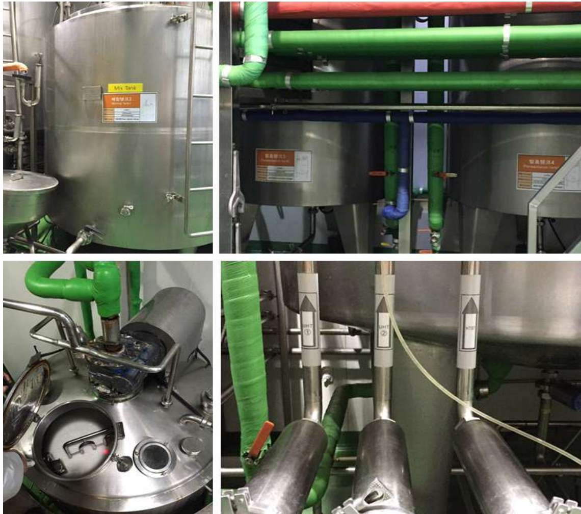
Fig. 49. 신바이오텍스 소재 고농축 발효유의 Pilot scale 제조 공정 (왼쪽 위: 배합탱크, 오른쪽 위 발효탱크, 왼쪽 아래: 혼합, 오른쪽 아래: 살균)
