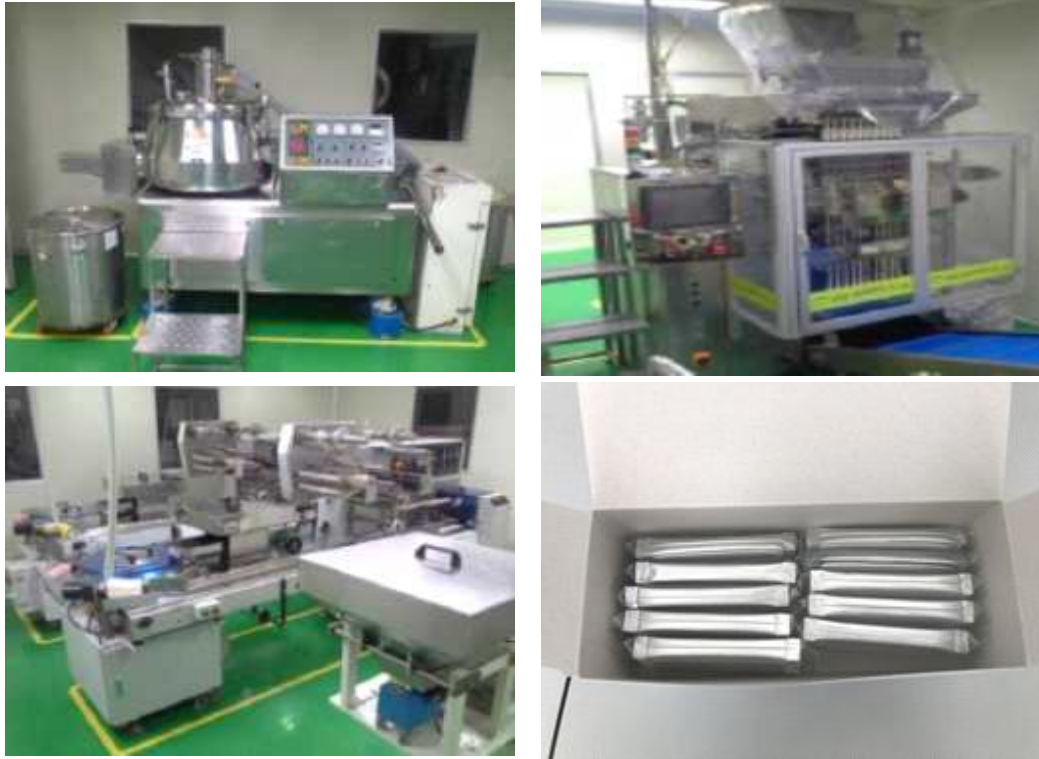
Fig. 52. 신바이오텍스 소재 고농축 혼합분말 제제 제조 설비 및 제품 - 혼합믹서, 스틱 충전기, 자동포장기
