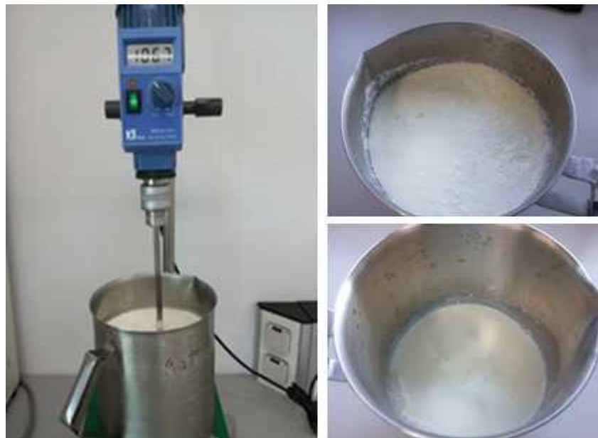
Fig. 44. 신바이오틱스 소재 발효유 제조 과정 (왼쪽: 교반, 오른쪽 위: 배양 직후 커드 상태, 오른쪽 아래: 커드 파쇄 후)
