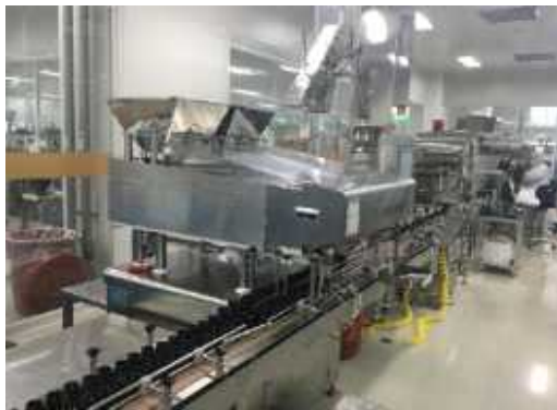
Fig. 53. 신바이오틱스 소재 고농축 하드캡슐 제제 제조 설비 및 제품 - 하드캡슐 충전기, 선별기, 병포장기
