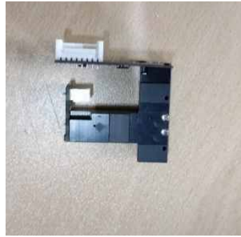
<광학계 몸통에 LED 보드와 PD 보드가 부착된 모습 >
