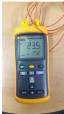
<온도 칼리브레이션시 사용한 계측기(좌:Fluke 열전상 온도계, 우:NI 9217 온도 측정 모듈)>
