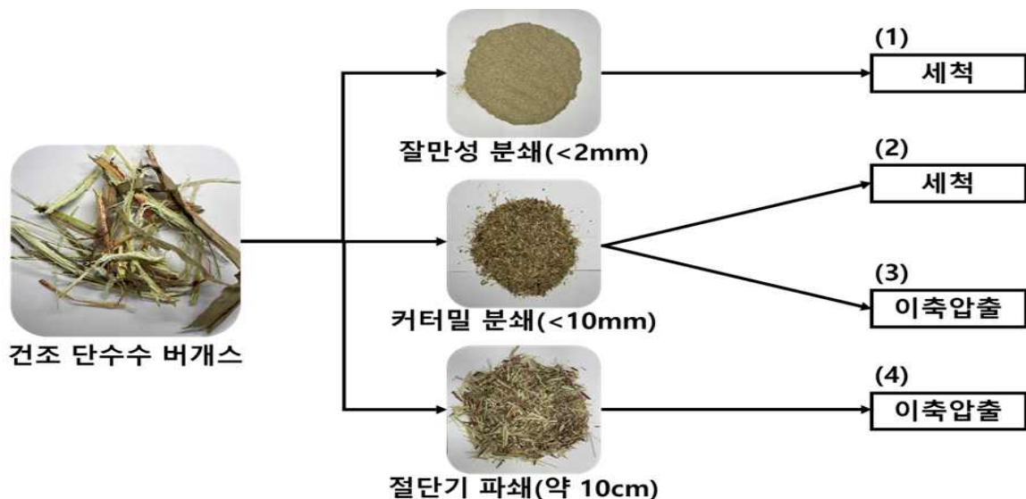
그림 19. 단수수 버가스 혼합당 추출을 위한 처리 방법
