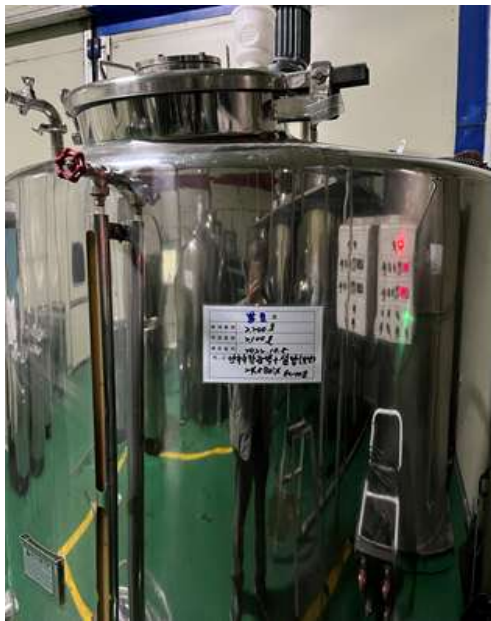
그림 64. 단수수 착즙액의 발효조(좌) 및 단수수 농축액 발효조(우)
