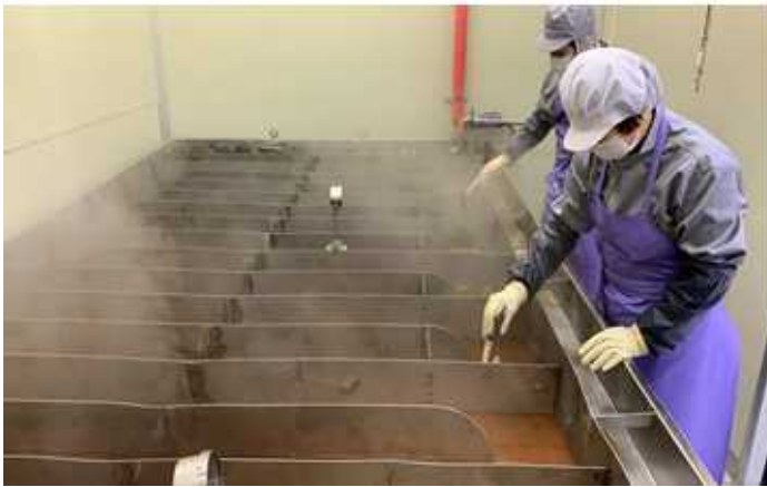
그림 62. 지그재그 스팀 농축기 시스템
