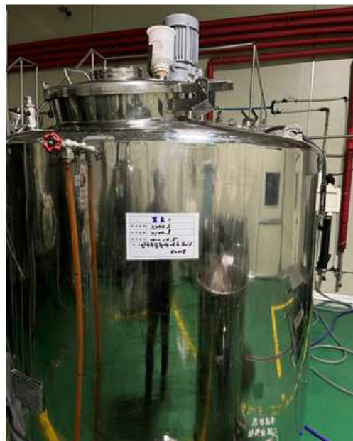
그림 64. 단수수 착즙액의 발효조(좌) 및 단수수 농축액 발효조(우)
