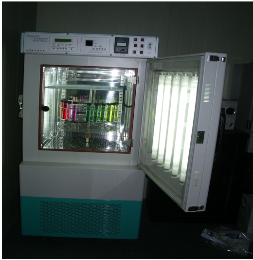
Fig 3-6 광안정성 측정 설비 (설정가능온도 : 0℃ ~ 50℃ , 광도 : 최대 11,000Lux)
