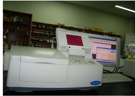
Fig 3-6 광안정성 측정 설비 (설정가능온도 : 0℃ ~ 50℃ , 광도 : 최대 11,000Lux)
