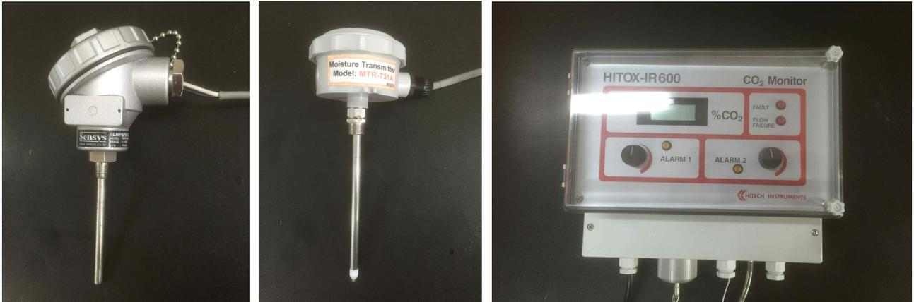
그림 13. 식물공장 내 설치한 온도, 습도 및 이산화탄소 측정 센서
