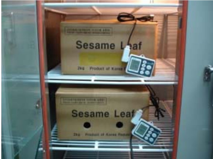
<사진 6> 향온항습기 내에서 통기공 유무에 따른 상자내부의 온습도 변화 측정
