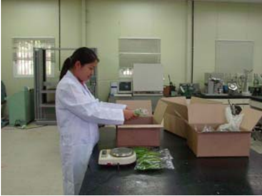
<사진 3> 깻잎, 풋고추, 시금치의 겉포장 골판지상자 적입시험
