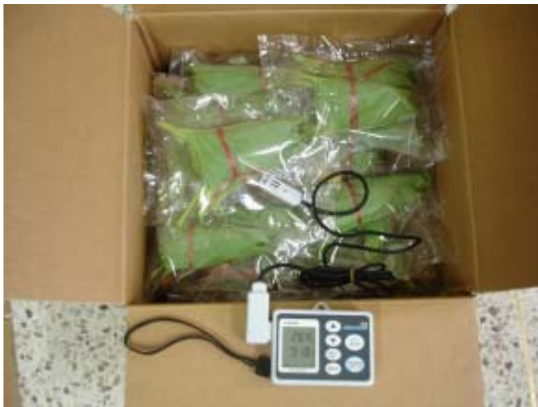
<사진 5> 깻잎 bag 내부에 온습도 기록계 설치 장면
