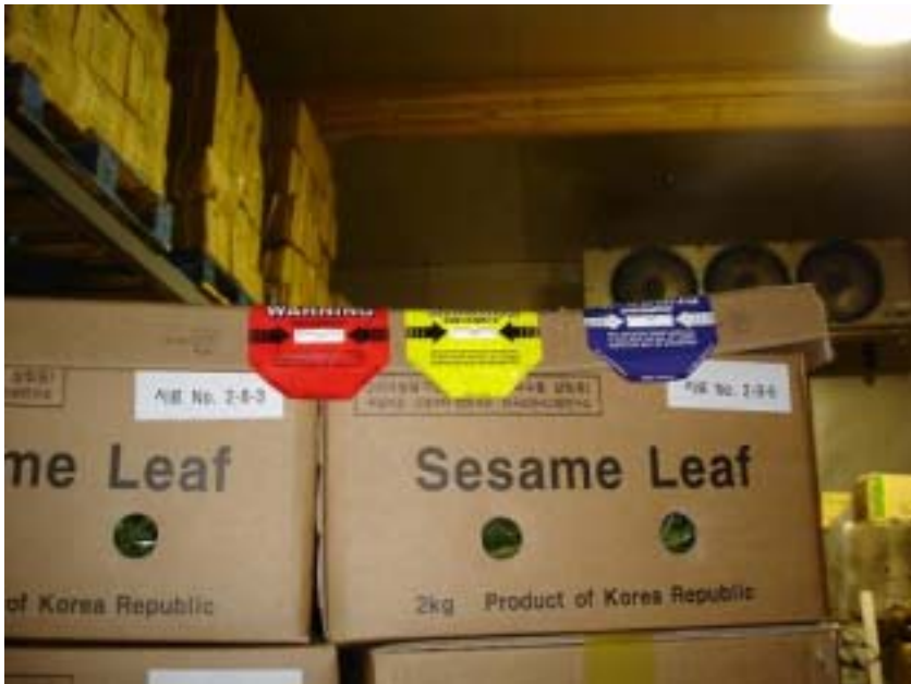
<사진 63> 일회용 진동·충격계(SHOCK WATCH) - 유통시험 후
