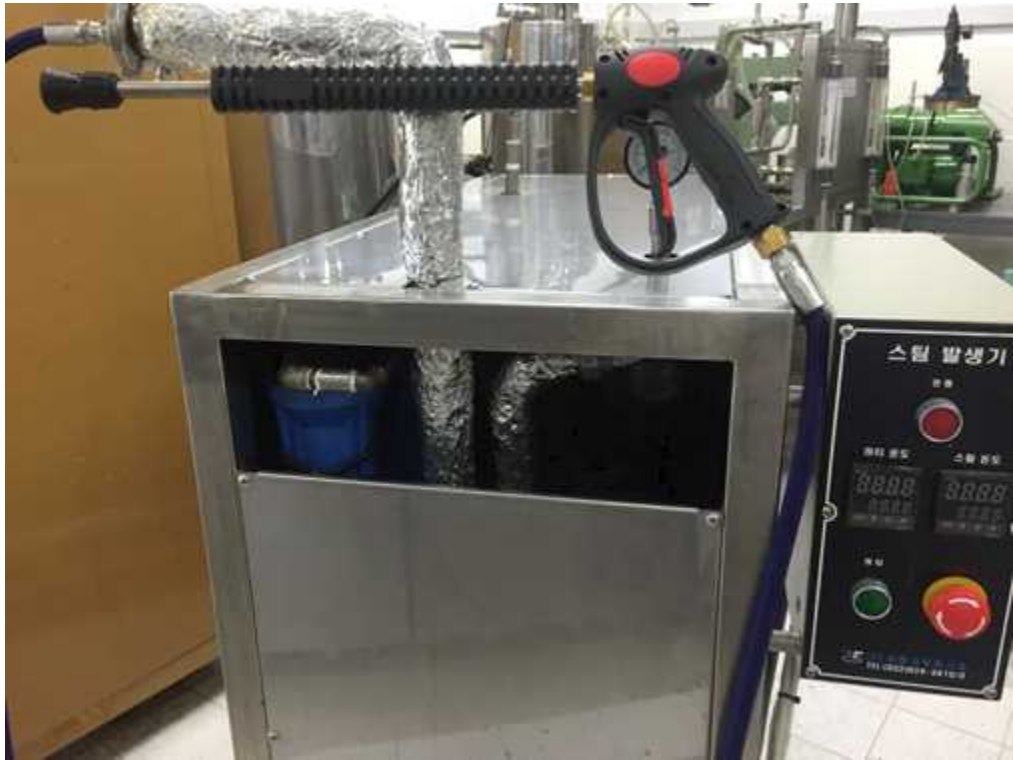
그림 1-77. 과열 수증기를 발생장치를 이용한 현장적용형 CIP 장비
