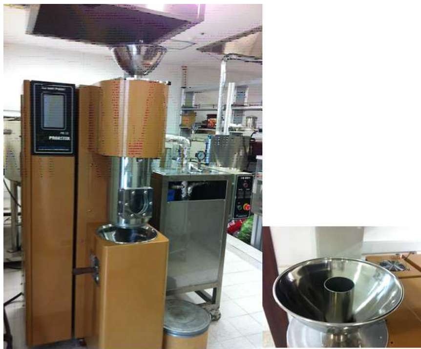
그림 1-12. 공기혼입 방지용 개량 호퍼 및 개량호퍼부착 유동층 과열수증기 처리장치
