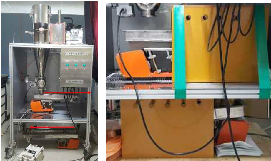
그림 2-30. Belt-type 장치가 연결된 pilot-scale IPL 장치(왼쪽)와 광원 램프가 설치된 모습(오른쪽)
