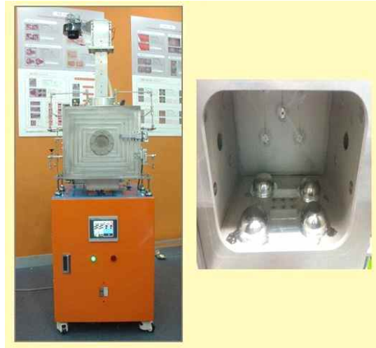
<그림 2> 마이크로웨이브-콜드플라즈마 복합처리 장치와 시료 처리 내부 공간
