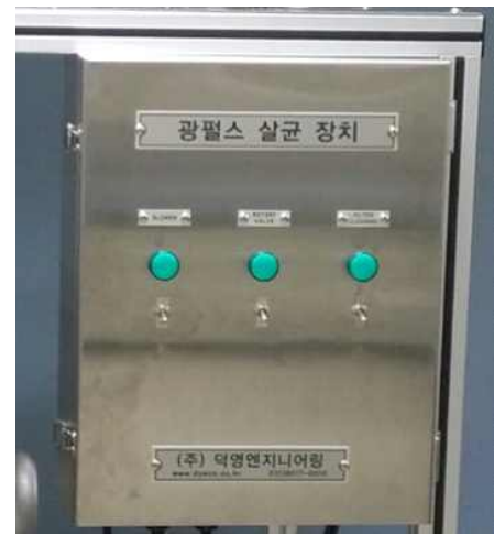
그림 2-25. 처리 조건 설정 버튼(왼쪽)과 장치 시작 스위치(오른쪽)
