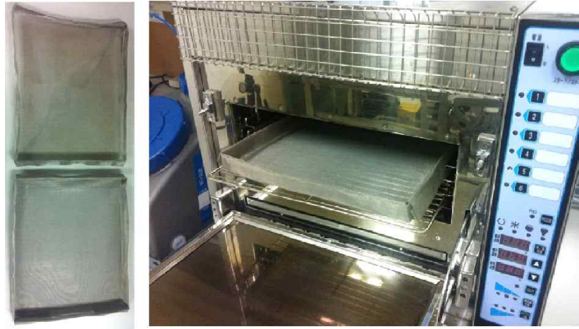
그림 4. 과열수증기 발생장치 일체형 오븐형 처리장치
