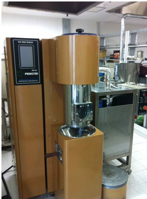
그림 1-9. 과열수증기 발생장치와 조합한 와류형 유동층 과열수증기 처리장치
