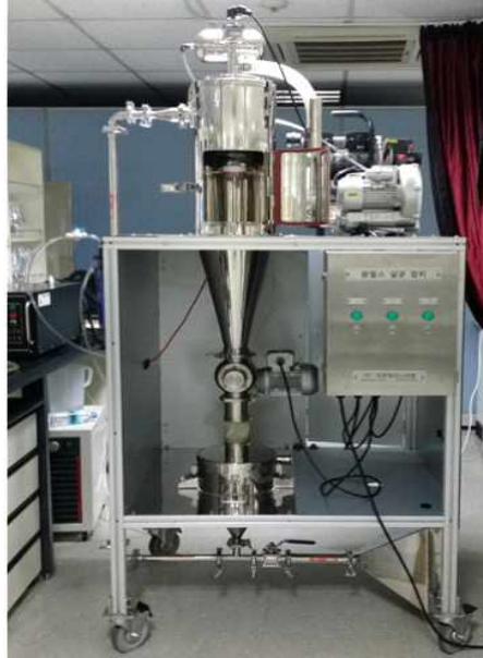
그림 2-20. 스테인리스 재질의 pilot-scale treatment chamber
