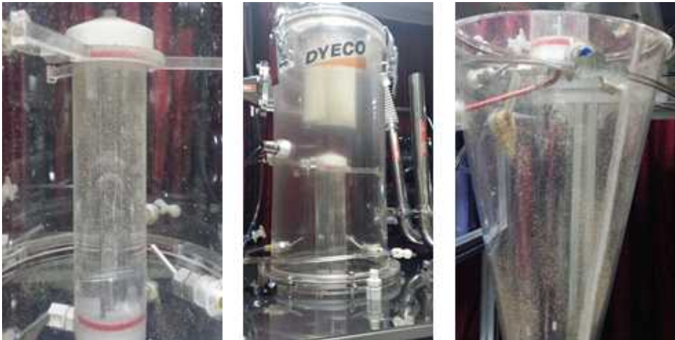
그림 2-21. 청소가 용이하지 않은 기존 광펄스 장치의 treatment chamber
