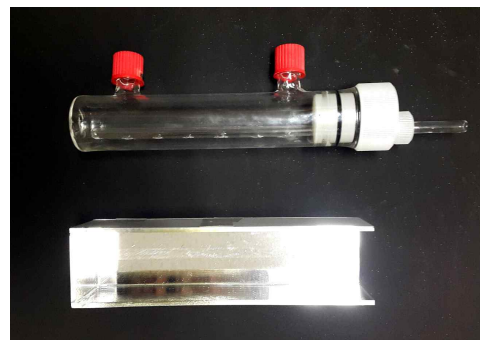
그림 4-37. 회전 원통형 석영 처리용기와 Inside mirror chamber 모식도와 사진
