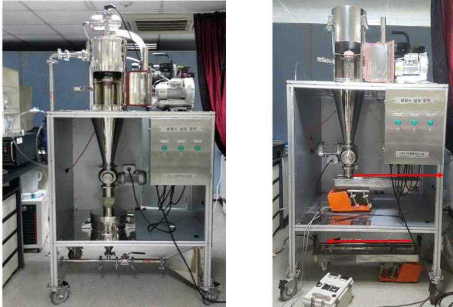
그림 1. Pilot-scale 광펄스 장치. Cyclone type 장치(왼쪽)와 belt type 장치(오른쪽)
