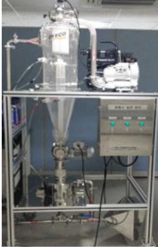
그림 2-15. 분체식품(종자 농산물) 살균용 광펄스 살균장치
