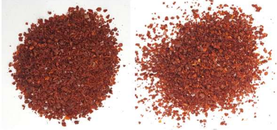
그림 2-1-13. 200℃의 과열 수증기 처리 후 나타나는 고춧가루의 외관 변화 (좌 : 처리 전 시료, 우 : 9초 처리).
