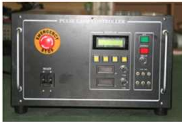
그림 2-5. 고전압펄스 트리거 발생 하드웨어(위) 와 광펄스 시스템 controller 외형(아래).
