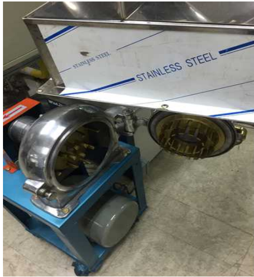
그림 1-80. 시 생산에 사용된 pin mill(mesh 교체형)
