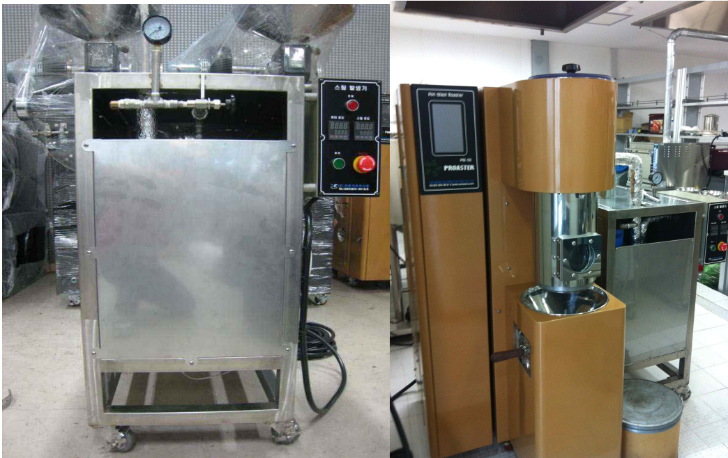
그림 3. 분리형 과열수증기 발생장치와 와류형 유동층 처리장치
