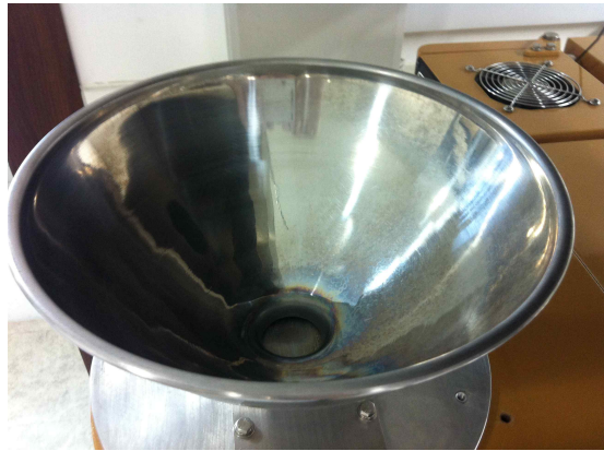
그림 1-10. 공기흡입 방지용 호퍼 및 호퍼부착 유동층 과열수증기 처리장치.
