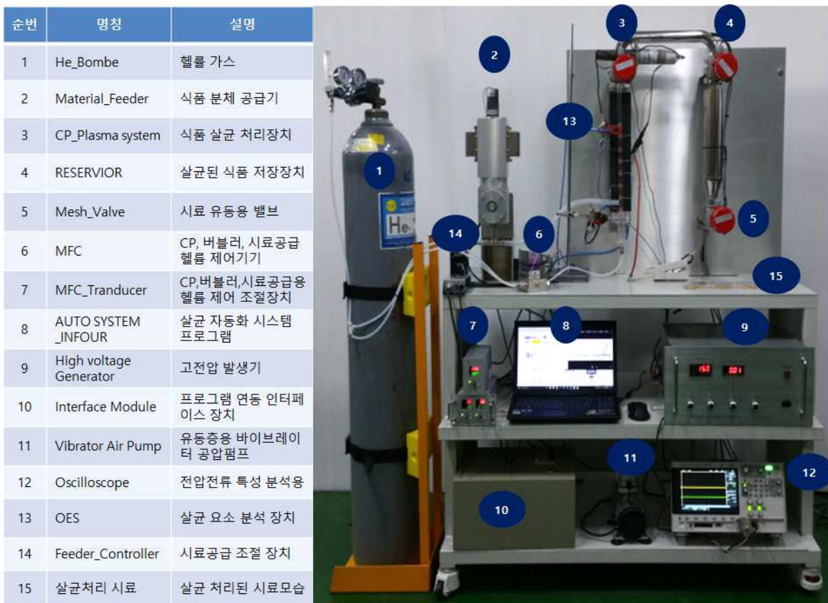
<그림 2> pilot scale의 유전체 장벽 방전 콜드 플라즈마 처리 장치
