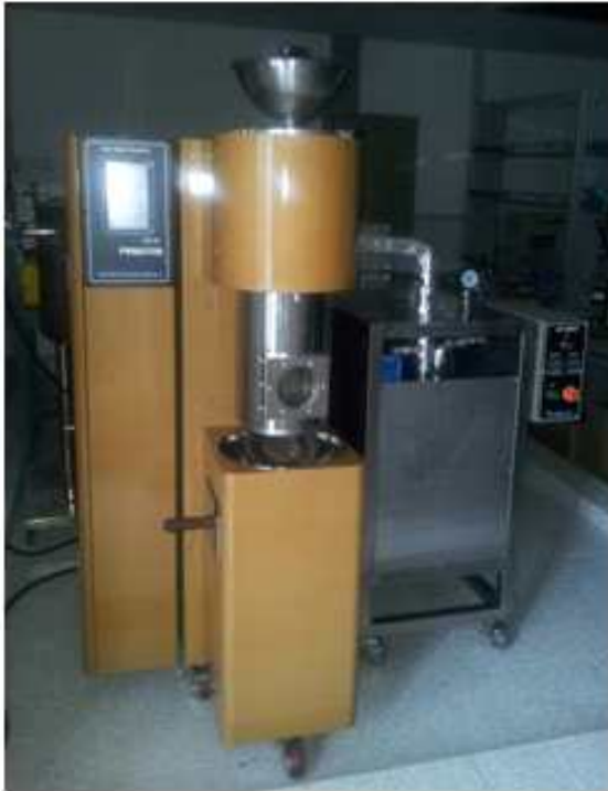
그림 1-10. 공기흡입 방지용 호퍼 및 호퍼부착 유동층 과열수증기 처리장치.
