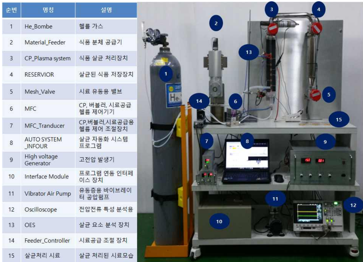
<그림 3> Pilot scale의 유전체 장벽 방전 콜드플라즈마 처리 장치
