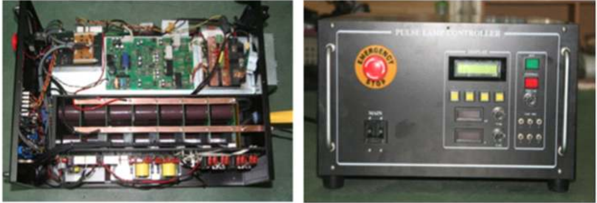
그림 2-12. 고전압펄스 트리거 발생 하드웨어(왼쪽) 와 광펄스 시스템 controller 외형(오른쪽).
