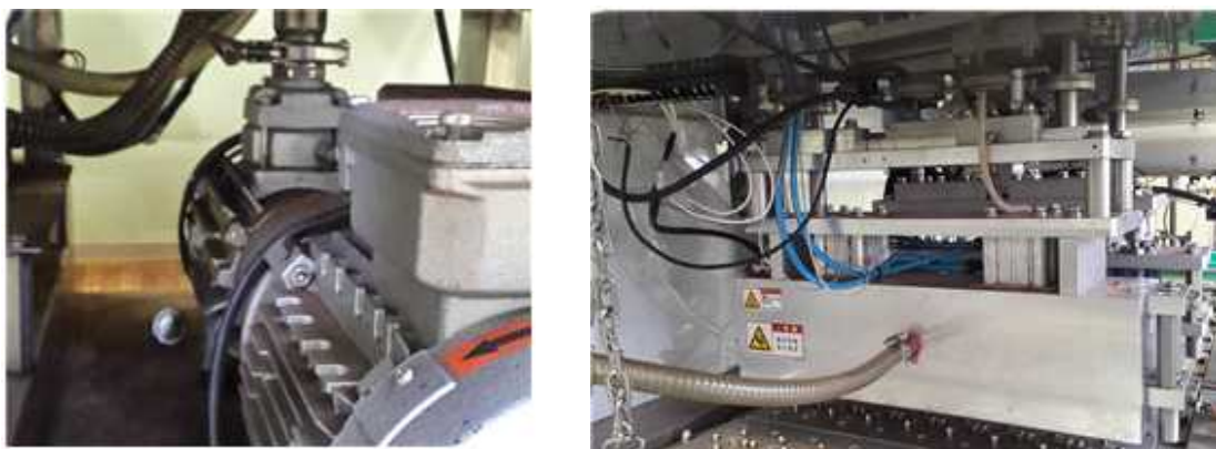
그림 30. 가스치환 챔버의 진공작업용 진공펌프(좌) 가스챔버구조 이미지(우)
