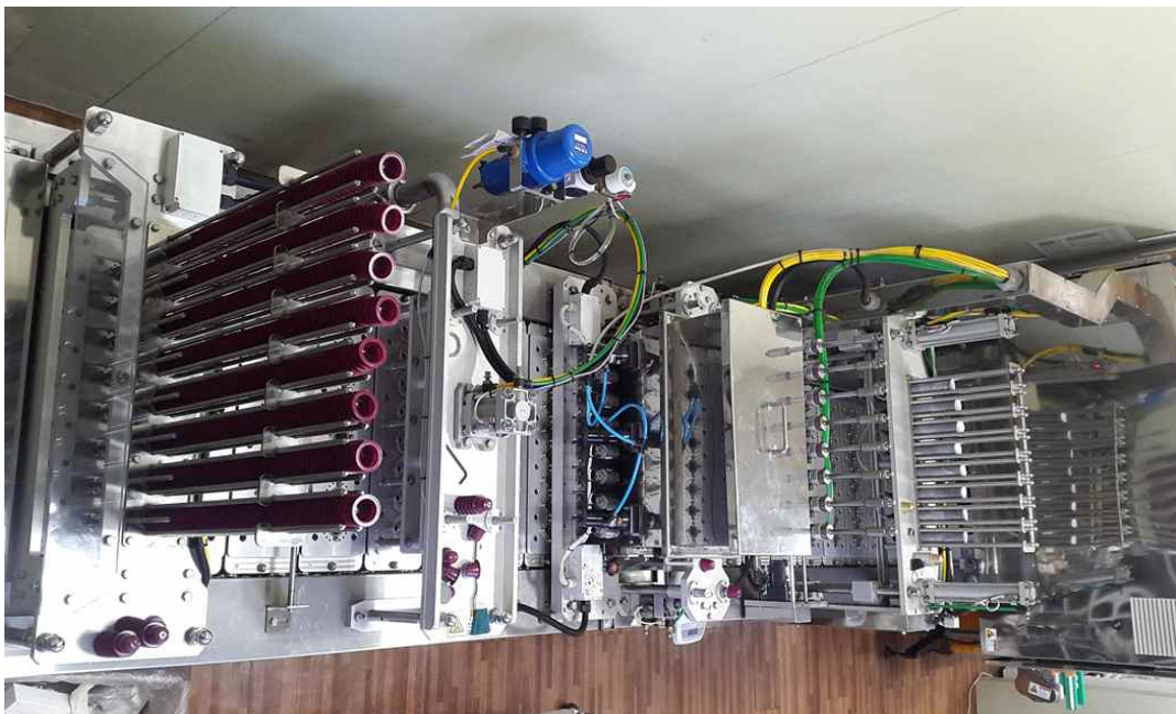
그림 14. 자체 설계 제작한 캡슐용기 자동 MAP 포장 연구설비
