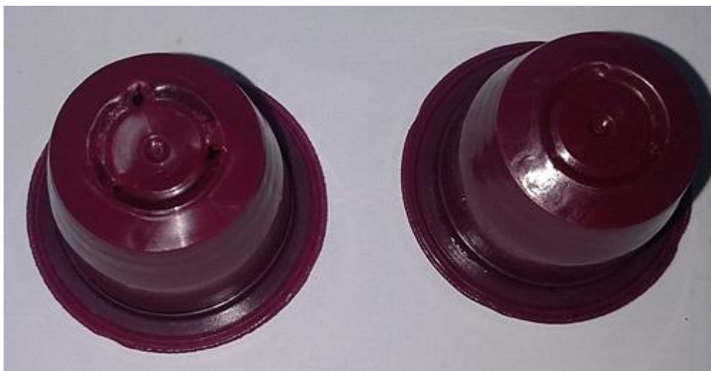
그림27. 캡슐머신의 천공메커니즘에 부합하는 캡슐(좌)와 미부합캡슐(우)
