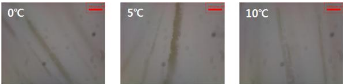
그림 1-3. Vedio microscope system( \times 500 ) 을 이용한 동결건조 후 잠열재 외관
