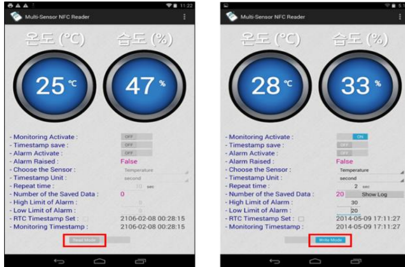
그림 4-12. 센서리더의 Read/Write 동작 Mode 시험
