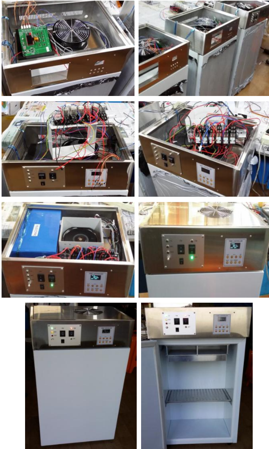
그림 4-36. 50 L 저온수배송용기 조립 과정
