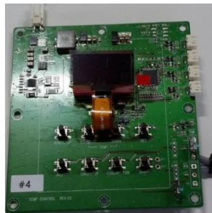
그림 4-32. OLED controller 기본 회로 구성도로 제작한 PCB 기판
