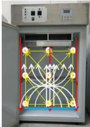
그림 4-37. 50 L 저온수배송용기 온도 및 풍속 측정 부위
