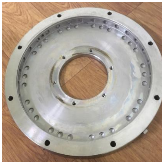
[그림 36-(b)] 원주방향 및 양쪽 표면에 딩플이 가공된 앞덮개(Front cover)의 실물사진 및 도면
