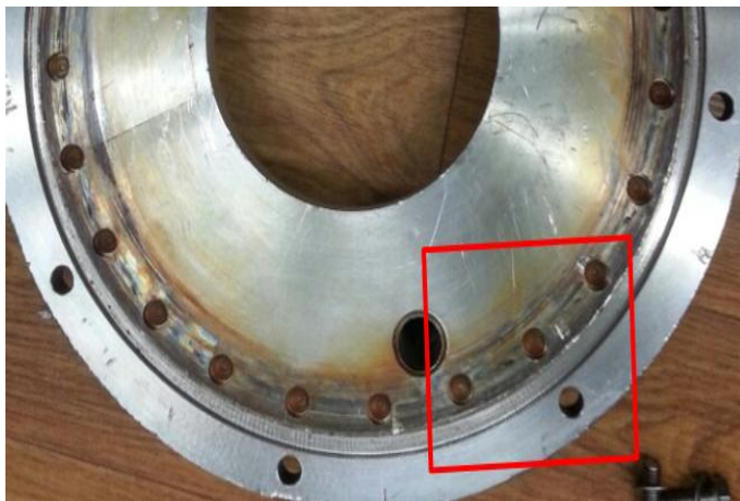
[그림 72] 15kw급 살균장치 뒷덮개(Rear cover) 출구부 주변 기계손상 사진
