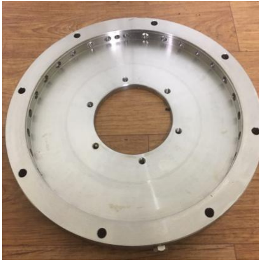
[그림 34-(b)] 원주방향에 댄플이 가공된 앞덮개(Front cover)의 실물사진 및 도면
