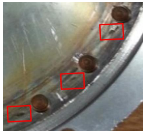
[그림 72] 15kw급 살균장치 뒷덮개(Rear cover) 출구부 주변 기계손상 사진
