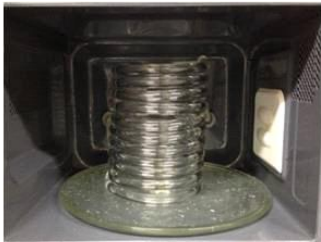
그림 3-23. 마이크로웨이브 연속 조사를 위해 전자레인지내에 장착된 나선형유리관
