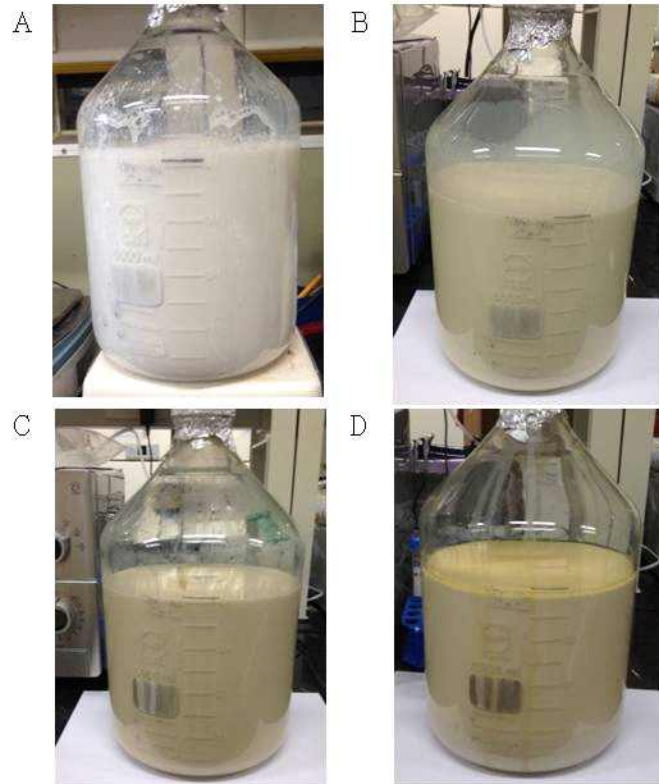
그림 3-16. Lactobacillus sakei Probio 65 농축액의 고압증기멸균기 처리에 의한 갈변화 4L을 유산균 용액( 1 \times 10^{11} CFU/mL)을 5L 유리병에 고압증기멸균기 3회 처리 A; 고압증기멸균기 처리 전, B; 1회 리, C; 2회 처리, D; 3회 처리
