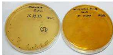
그림 3-29. 마이크로웨이브 살균장치 처리 후 생균 확인 살균장치의 처리시간 조정에 의한 완전 살균. 0.1ml의 1 \times 10^{11} CFU/mL 농도의 Lactobacillus sakei Probio 65 균주시료에서 생존 균주 관찰되지 않음
