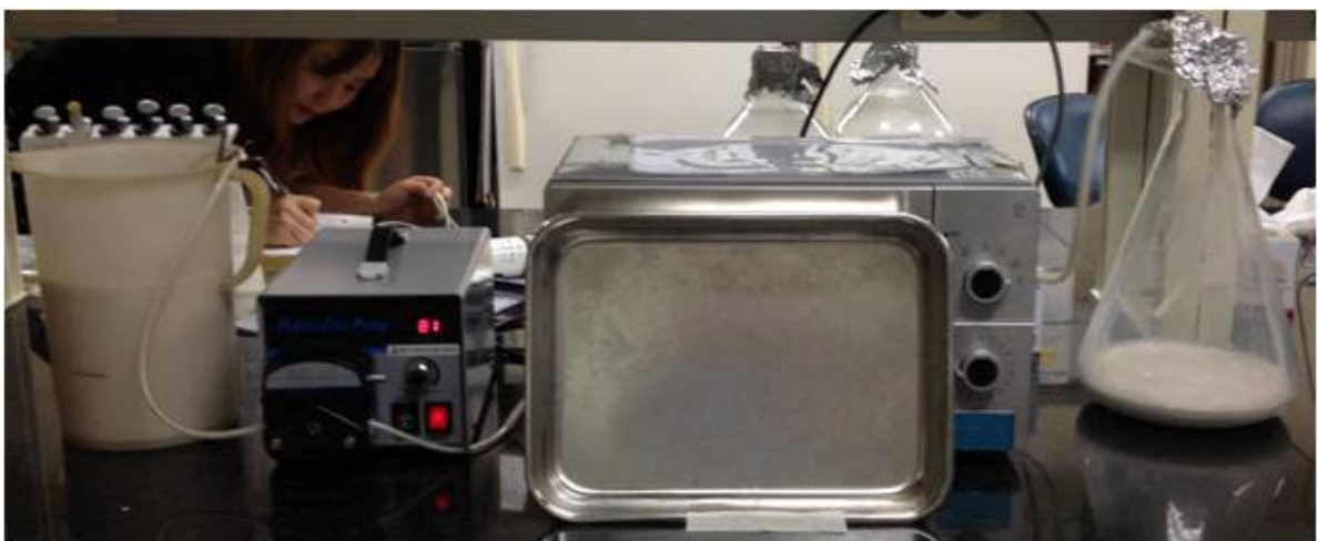
그림 3-26. 단독 운전 마이크로웨이브 살균장치 운전
