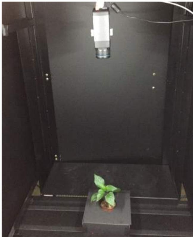
그림 188. 챔버 내부에 이송된 대상체의 온도 측정 모습
