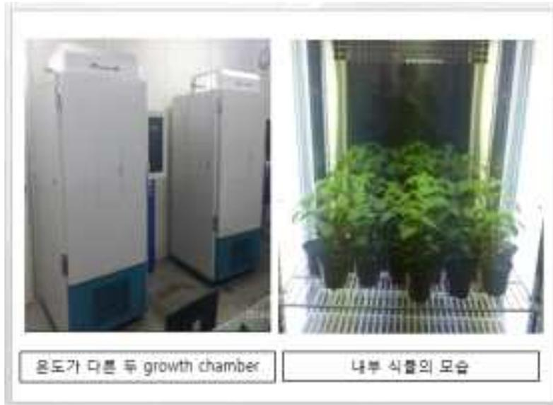
그림 31. Growth chamber를 이용한 생육환경조절
