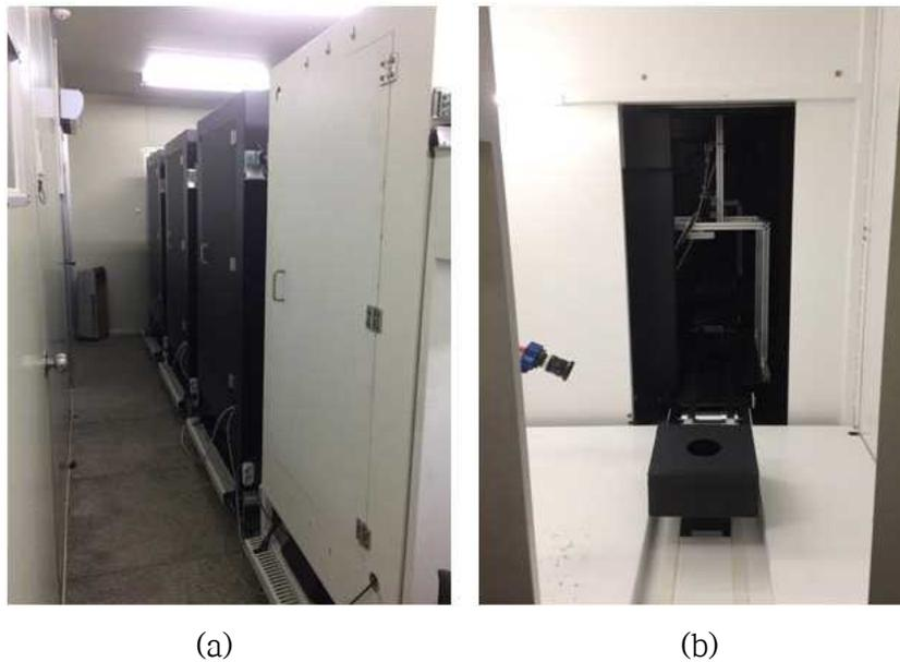
그림 193. Small-scale HTS 프로토타입 (4 챔버형) 실제 사진 (a) 외관, (b) 내부
