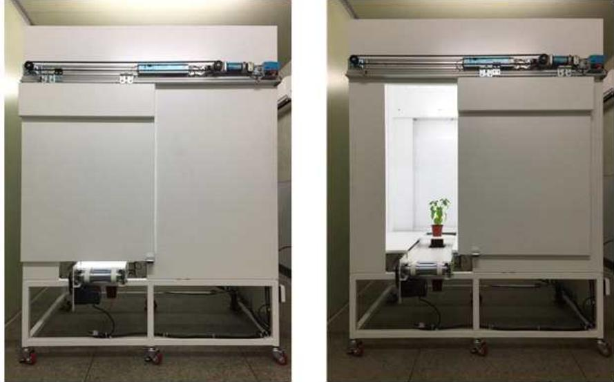
**그림 194.** 시료 투입(방출)시 작동되는 자동개폐 시스템
