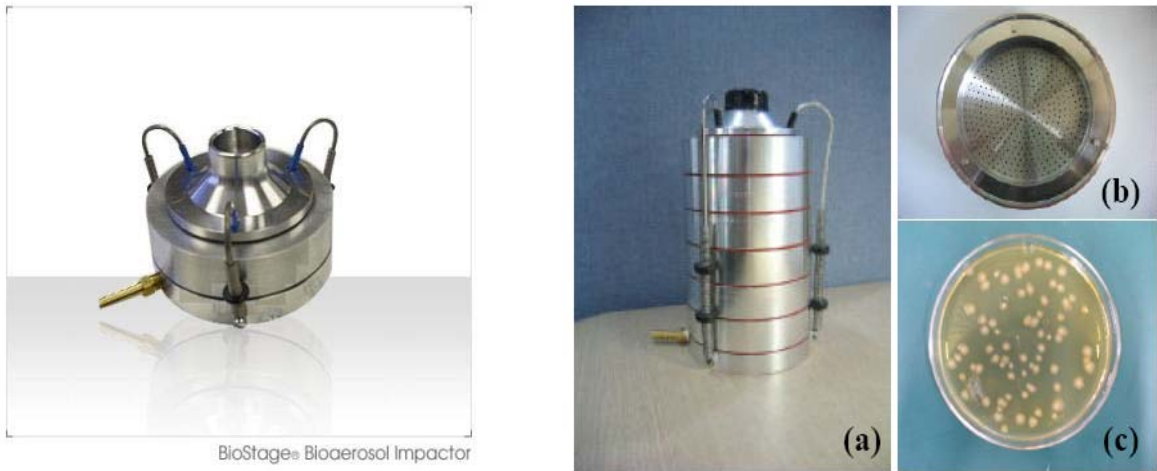
<그림-3> 공기시료 채취장비 (Left: 1단 앤더슨 샘플러, Right: 6단 앤더슨 샘플러)
