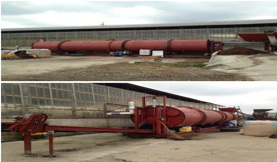
<그림-15> 측정 대상 원통 수평형 고속 퇴비화 장치
