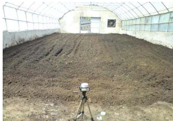
1단 앤더스 샘플러를 이용한 부유 미생물 시료채취 모습(C3 지점)
