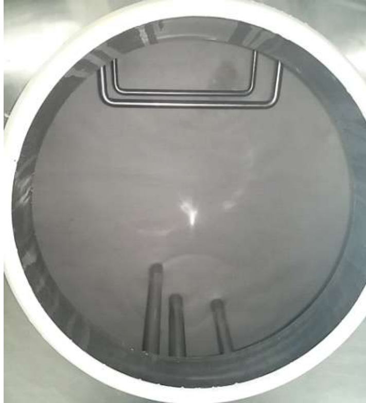
Figure 4-70. 배합탱크 내부 사진.
