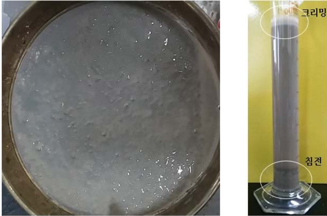
Figure 4-76. 레토르트 후 BCAA 뉴케어 검은깨맛의 메시망 통과 직후 사진(왼쪽) 및 메스실린더 10일간 보관 후 사진(오른쪽).
