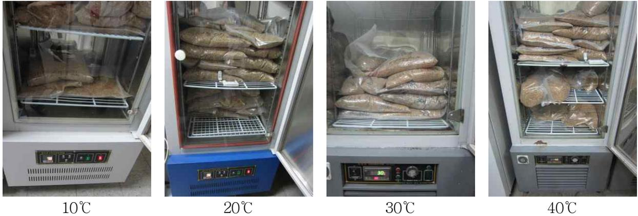
그림 3-2-87. 우리밀의 저장온도(10°C, 20°C, 30°C, 40°C)별 저장실험에 사용된 B.O.D Incubator
