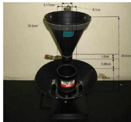
그림 3-2-40. 산물밀도 측정장치의 주요 제원(mm) 및 Seedburo사의 산물밀도 측정장치
