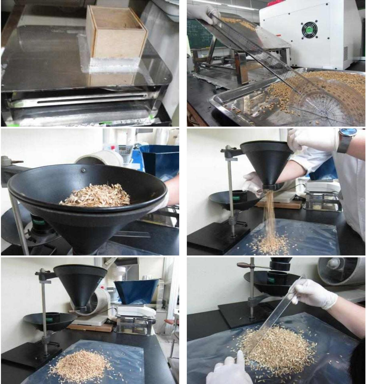
그림 3-2-46. 동안식각 및 정안식각 측정
