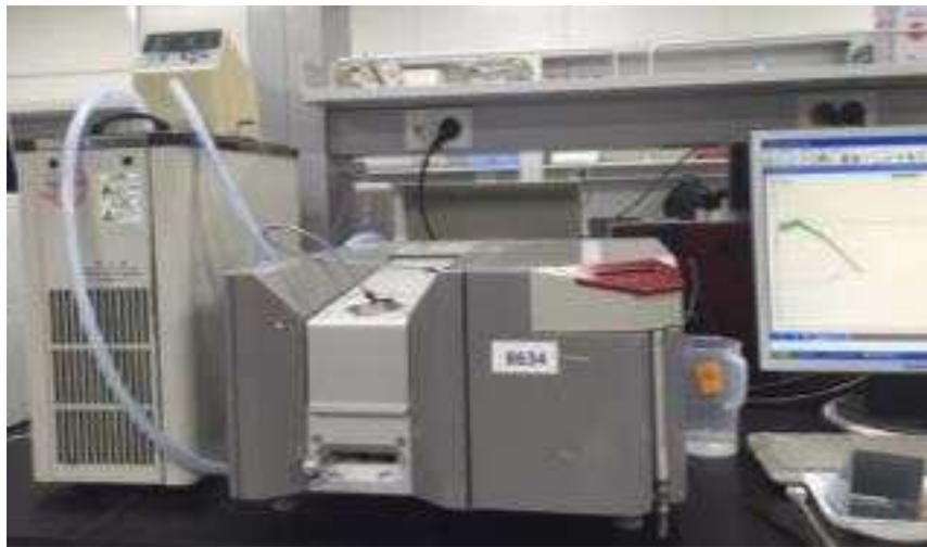
그림 3-1-150. 밀기울별 밀가루의 반죽 특성 분석에 사용된 Mixolab
