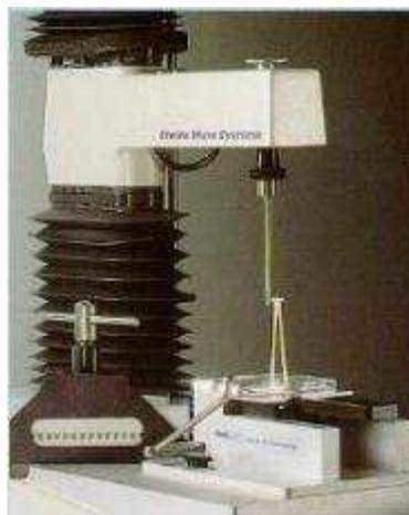
그림 3-1-3. 반죽의 신장성을 측정하기 위해 사용된 Rig
