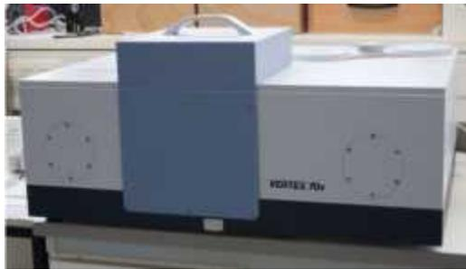
그림 3-1-122. 밀가루의 분자구조 분석에 사용된 FT-IR 기기
