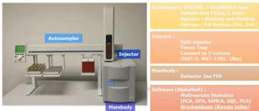
그림 3-1-275. 청밀 전밀가루의 향 분석에 사용된 e-nose (Heraclese 장비)
