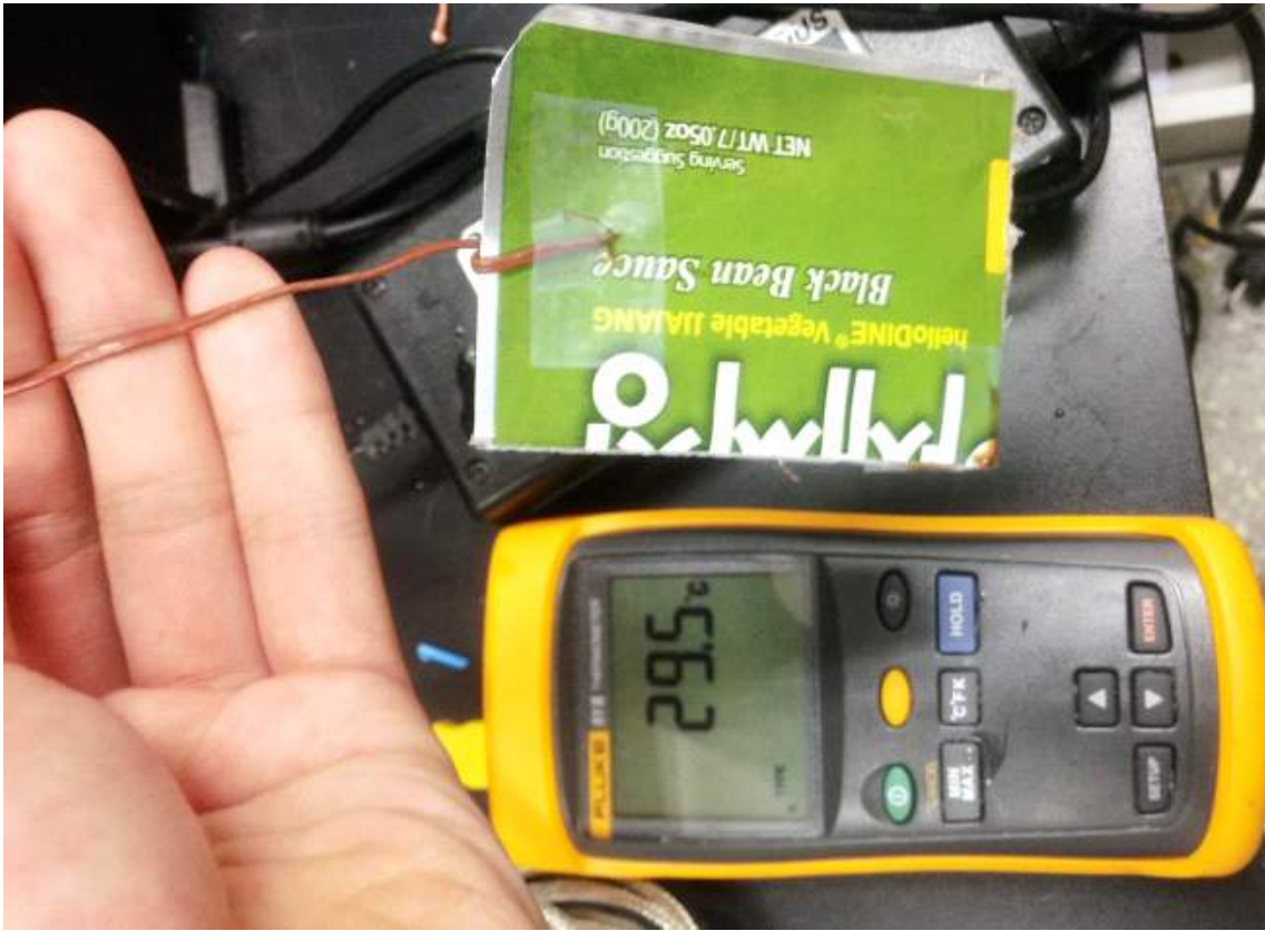
[ 샘플 로딩 및 시료 내부 온도 관찰을 위한 측정기기 설치 모습 ]
