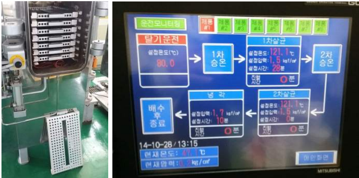
[레토르트 기기 내부 형태(좌)와 Control Panel 의 공정 진행도]
