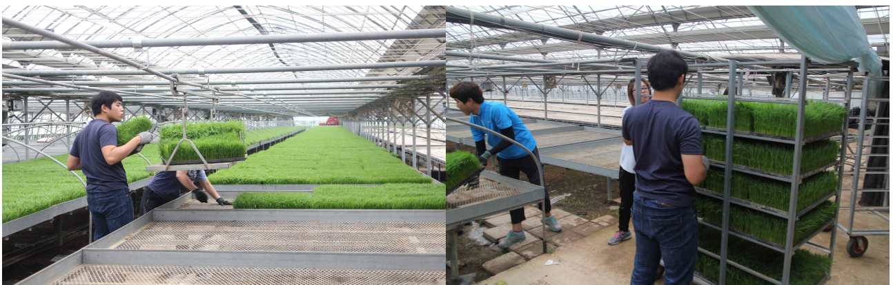
그림 2-31. 두상모노레일(좌)과 대차(우)를 이용하여 트레이를 운반하는 모습.
