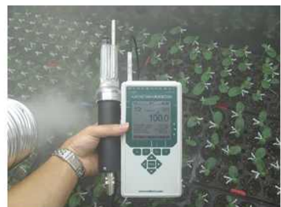
그림 2-166. 습도측정 센서(Almemo-2890-9, Ahlborn Mess-und Regelungstechnik GmbH, Holzkirchen, Germany).
