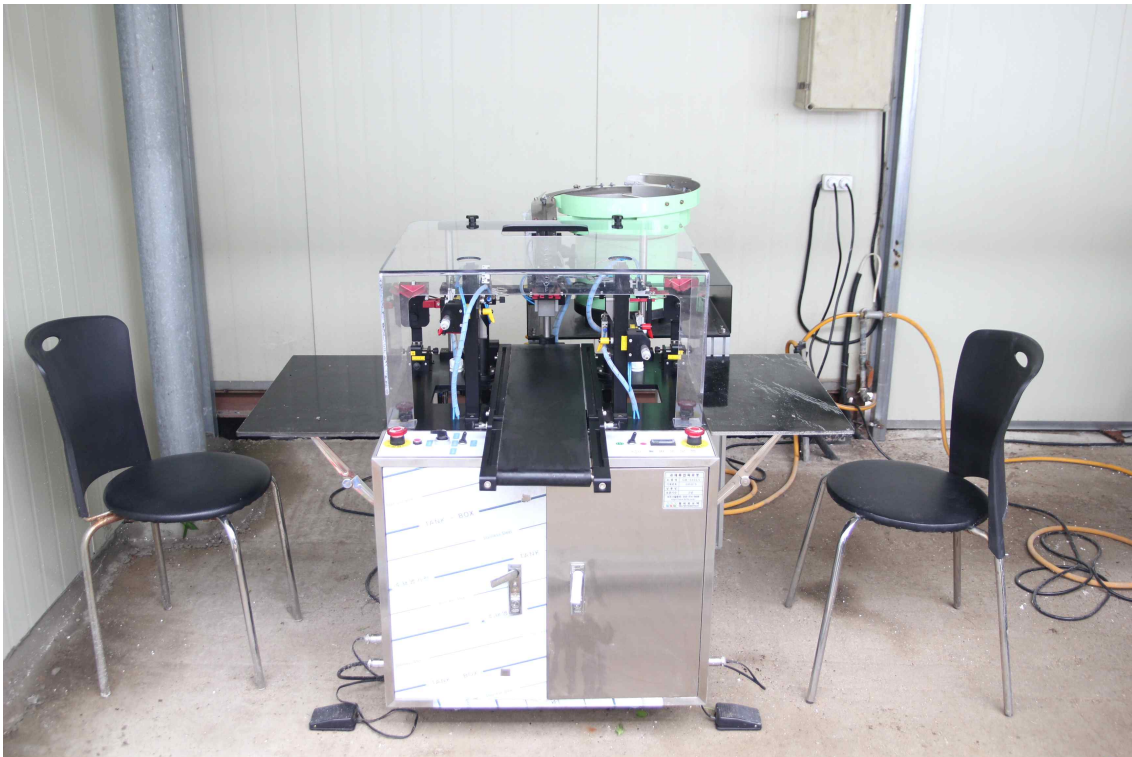
그림 2-3. 실험에 사용된 접목로봇 장치의 설치모습.
