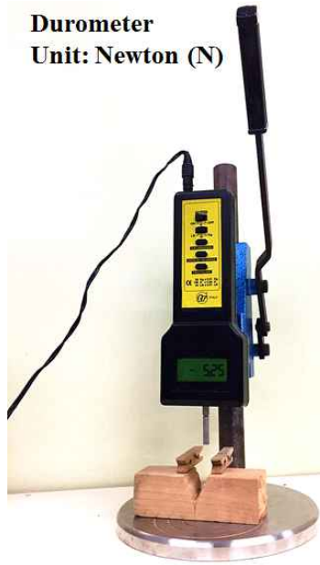
그림 2-168. 경도계를 사용한 접합부의 경도 측정.
