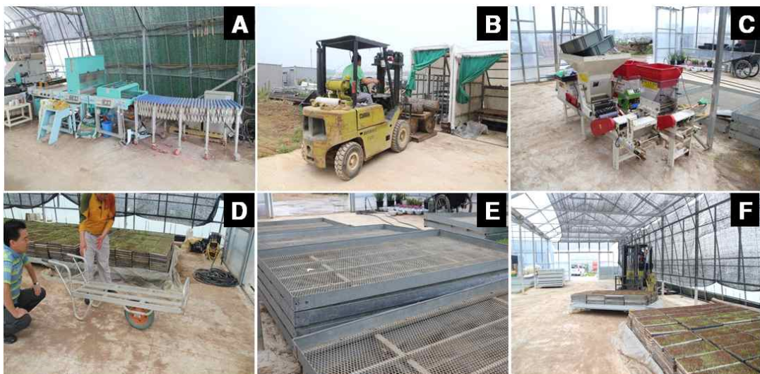
그림 2-37. 육묘장에서 이용되고 있는 자동 기계 및 수동 장비(A, 채소 육묘용 자동파종기; B, 지게차; C, 별씨 육묘용 자동파종기; D, 손수레; E, 육묘상; F, 지게차를 이용한 육묘 상 운반).
