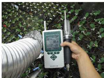
그림 2-166. 습도측정 센서(Almemo-2890-9, Ahlborn Mess-und Regelungstechnik GmbH, Holzkirchen, Germany).
