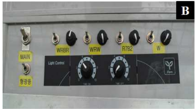
그림 2-108. LED가 설치된 5단 선반: A, 5단 선반; B, 광도 및 타이머 조절 장치.
