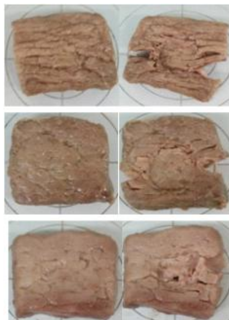
그림 3-30. A, B, C(위쪽부터) 처리 후 시료의 경도 측정 전, 후 형태
