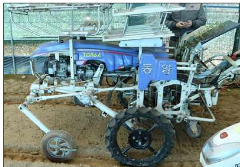
그림 14. 유식물체 고구마 정식을 위한 트레이 및 정식기 시험. (a) (주)동양물산기업 하우스시험장. (b) 엽채류정식기 PVZ1-60D. (c) 양과정식기 TOP6
