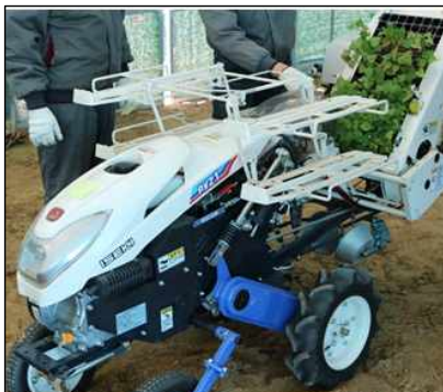
그림 14. 유식물체 고구마 정식을 위한 트레이 및 정식기 시험. (a) (주)동양물산기업 하우스시험장. (b) 엽채류정식기 PVZ1-60D. (c) 양과정식기 TOP6
