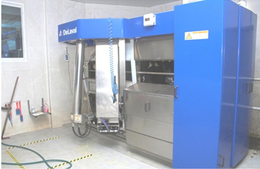
〈그림 2-5〉 자동로봇착유시스템(드라발)
