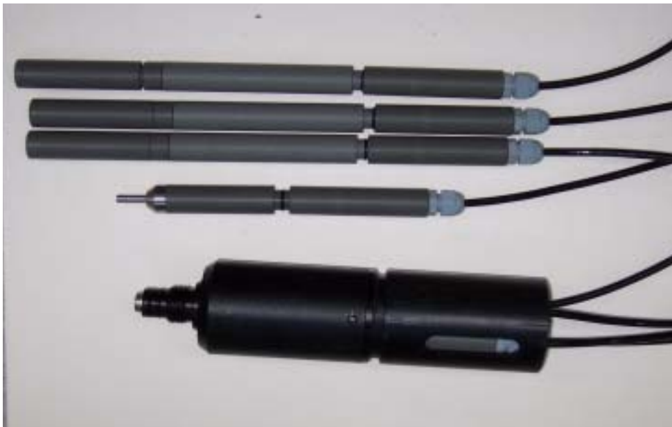
<그림 6-23> 다채널 측정장치에 연결한 염농도와 온도센서
