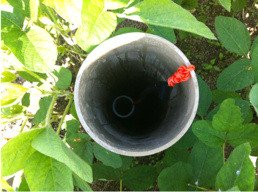
[그림 3.6] 지하수위 관측공 보호 및 수위계 설치
