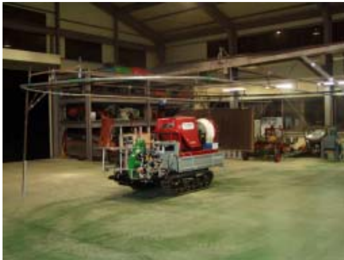
그림 3.2.14 실험실에 설치한 오버헤드 가이드스 레일의 전경.
