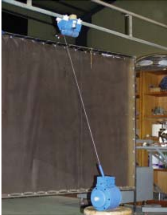
그림 3.2.6 조립된 주행경로 결정 센서의 모습(2차 프로토타입).
