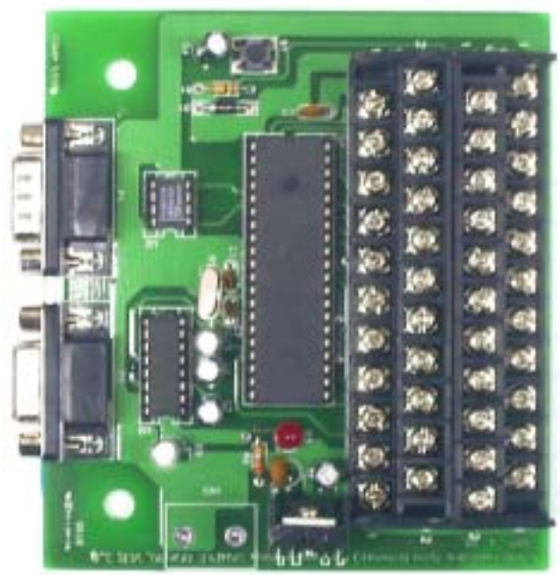
그림 3.3.13 PIC 18F448 기반 ECU의 완성된 모습(프로토타입).
