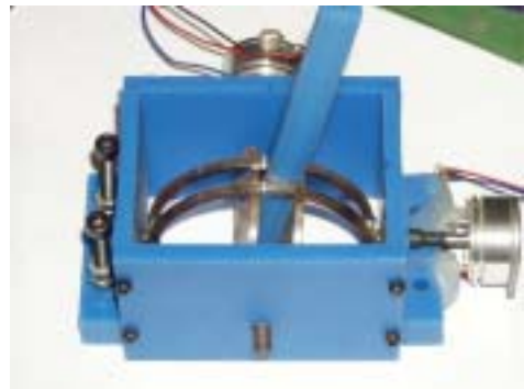
그림 3.2.5 각도 측정장치의 모식도와 실제 모습.
