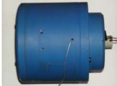
그림 3.2.4 케이블 권취장치의 모식도와 실제 모습.
