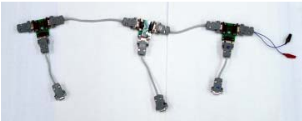
그림 3.3.15 CAN 버스 T형 연결단 및 종단 저항이 설치된 연결단.
