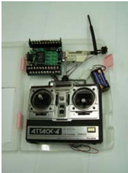
그림 3.4.21 리모트 컨트롤러와 무선 송신용 마이크로프로세서 인터페이스.
