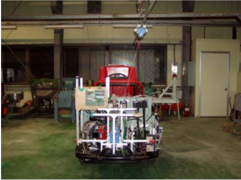
그림 3.2.9 과수방제기의 무인주행을 위한 주행경로 결정센서.
