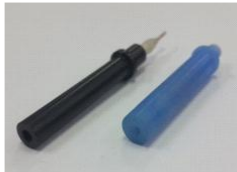
그림 3-6-1. 제작한 이온선택성 막 (좌)와 이온선택성 전극(우)
