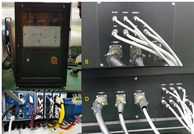
그림 3-5-38. 장치 제어부 세부 구성 (A : 제어반 및 사용자 조작용 디스플레이, B : 구동부 센서 및 전원 커넥터 연결 패널, C : 제어부 센서 및 전원 커넥터 연결 패널, D : 컨트롤러)
