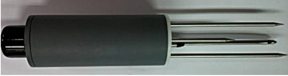
그림 3-7-9. 제작된 유기배지용 수분,EC,지온,pH가 측정가능한 센서
