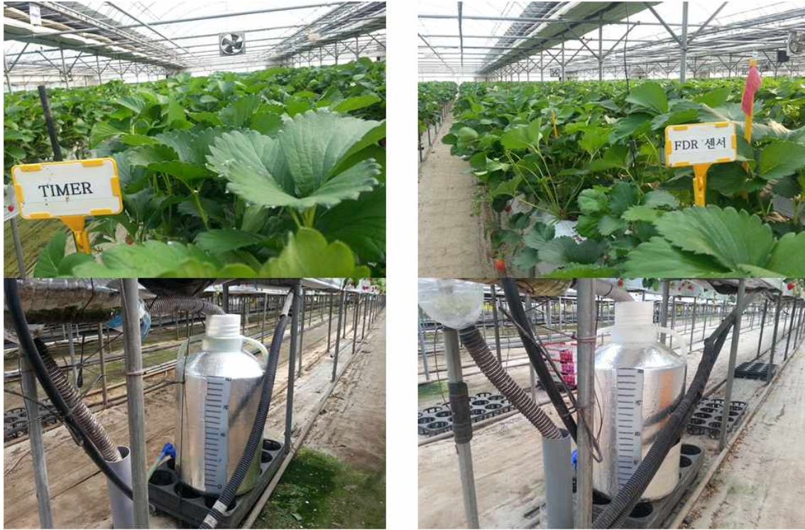
그림 3-1-22. 급액 방식에 따라 배출된 배액량 측정 (좌, TIMER, 우, FAI)
