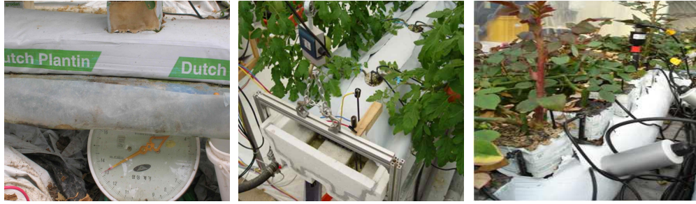
그림 1-2-5. 배지의 함수량을 측정하는 다양한 방법들 (좌로부터 중량법, 배액전극센서, 배지수분센서)
