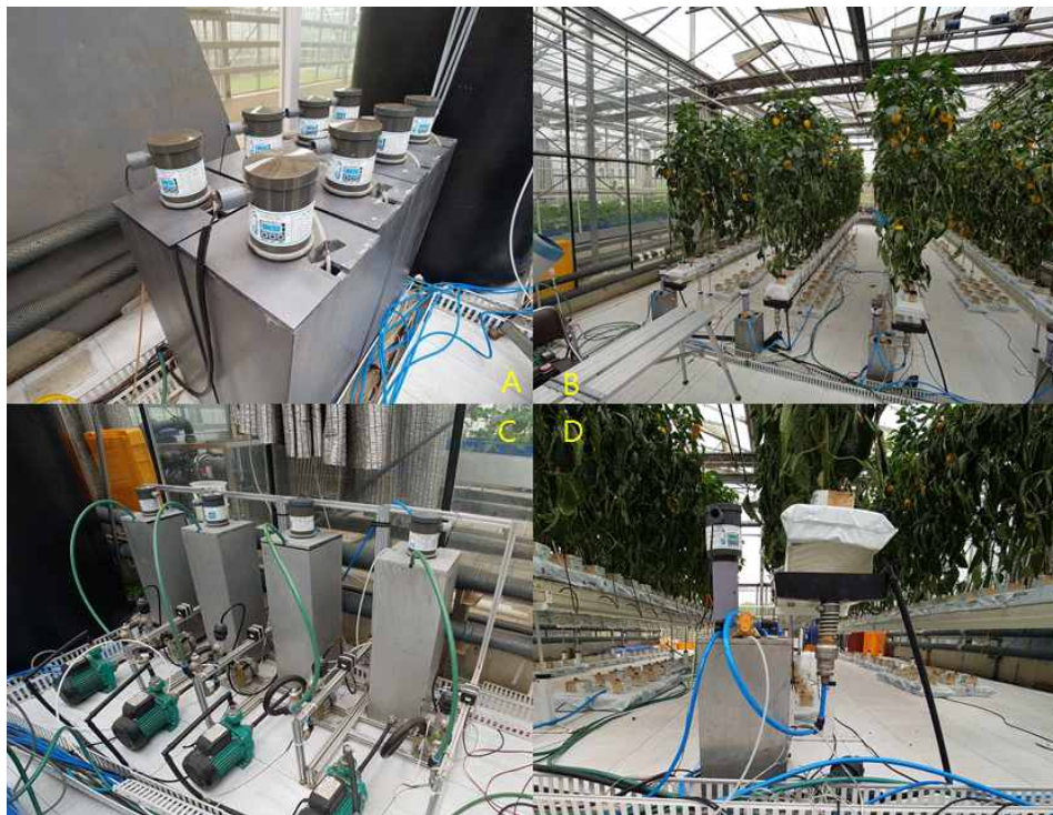
그림 3-5-14. 실증 실험 장치의 전체적 구성(A: 농축양액 탱크, B: 작물 재배상, C: 양액 혼합부, D: 배액 수집부)
