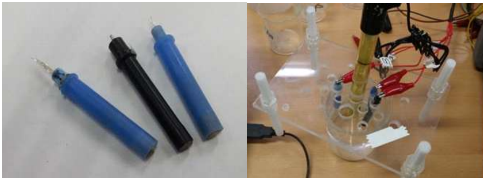
그림 3-6-2. 제작된 코발트 전극 (좌)와 센서 감도 측정 실험 (우).
