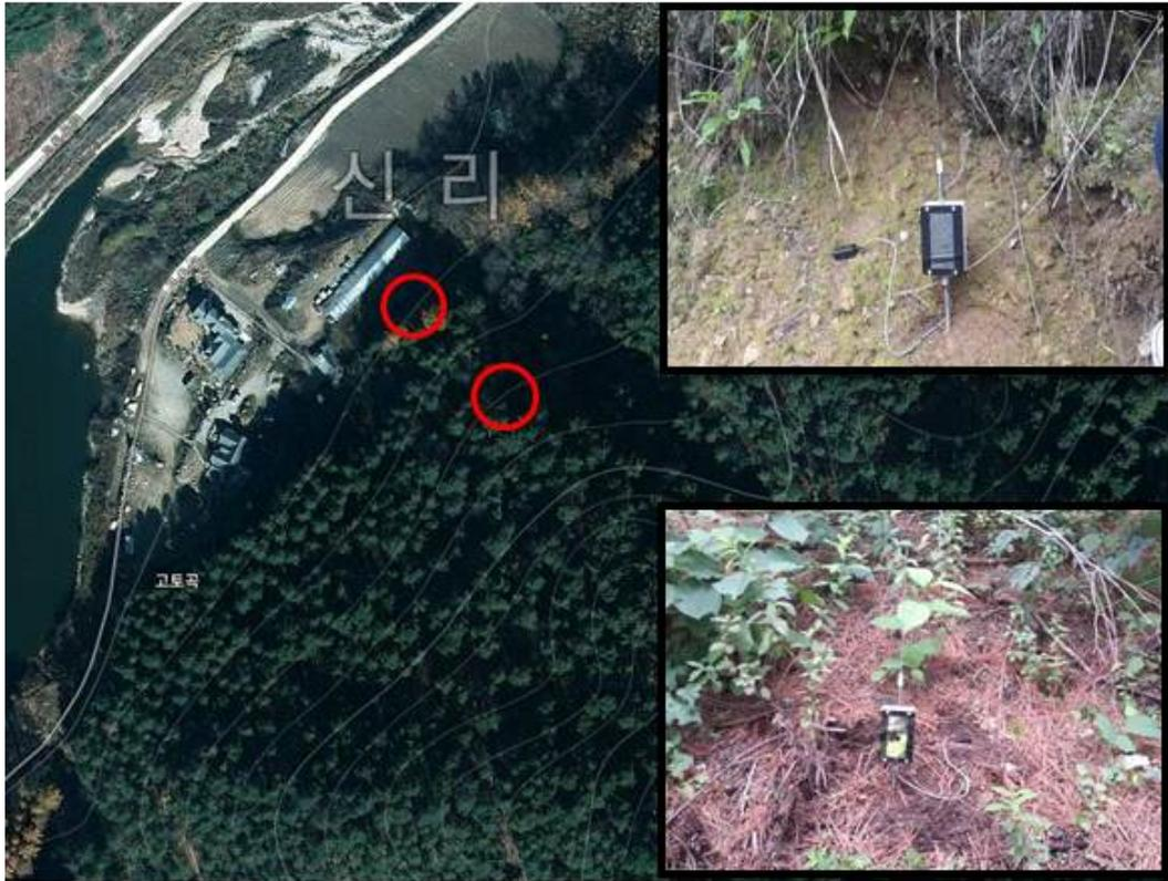
그림 3-4-10 | 기울기 센서(PHL#1, #2) 설치 위치 및 현황
