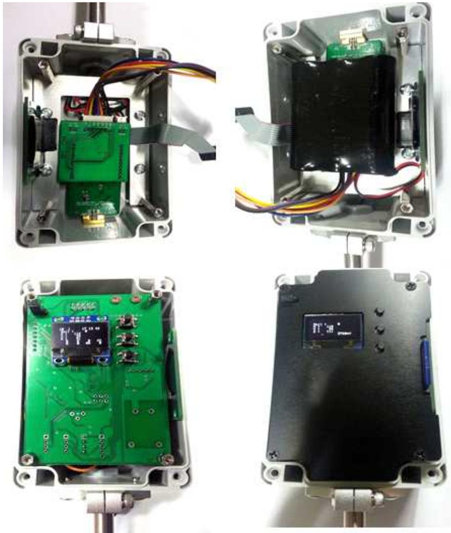
그림 3-1-45 | 지면 변위 센서 합체 내부 모습
