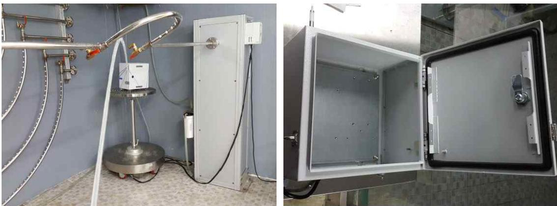
그림 3-1-62 | 방수시험 후 내부확인
