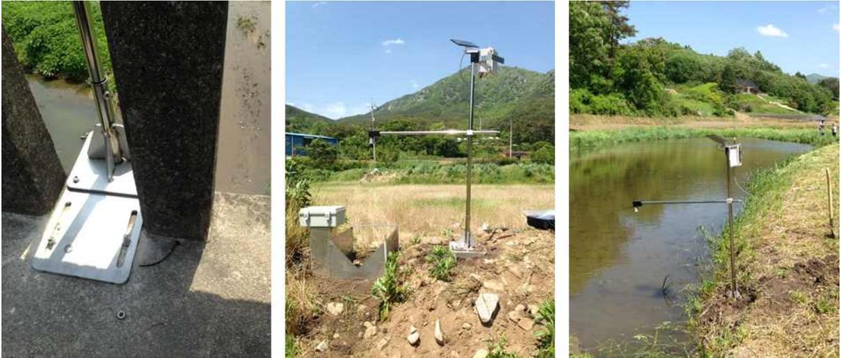
그림 3-1-27 | 콘트리트 구조물 및 매립을 통한 수위 센서 마운트 방법
