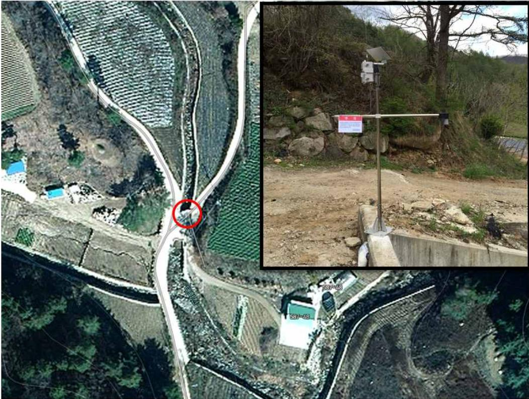
그림 3-4-4 | 수위 센서(PSF#1) 설치 위치 및 현황
