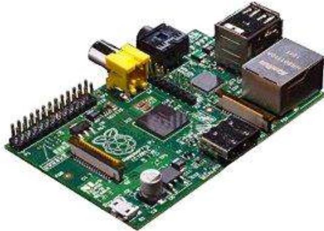
그림 3-1-51 | Raspberry Pi Model B
