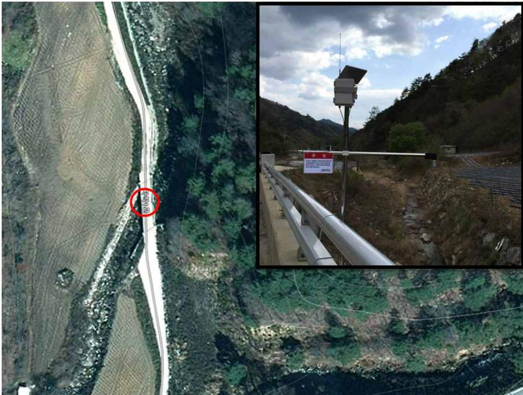
그림 3-4-5 | 수위 센서(PSF#2) 설치 위치 및 현황
