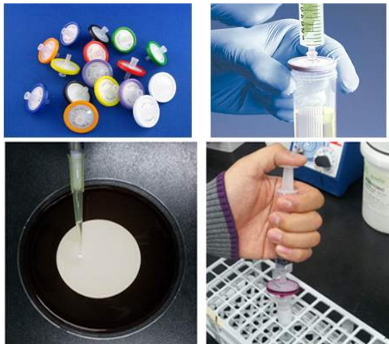
그림 3.15 상용화된 실린지 필터(좌상), 실린지 필터 사용(우상) 멤브레인 필터 방법(좌하), 본 연구에서의 실린지 필터 방법(우하)
