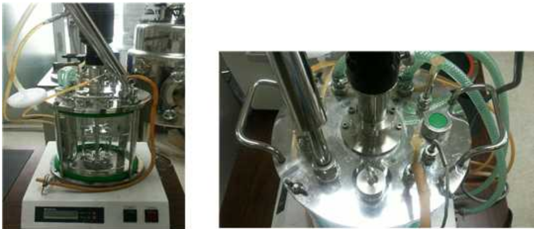
그림 40. 5 L 배양 및 milking 기능을 보유한 milking-배양기.
