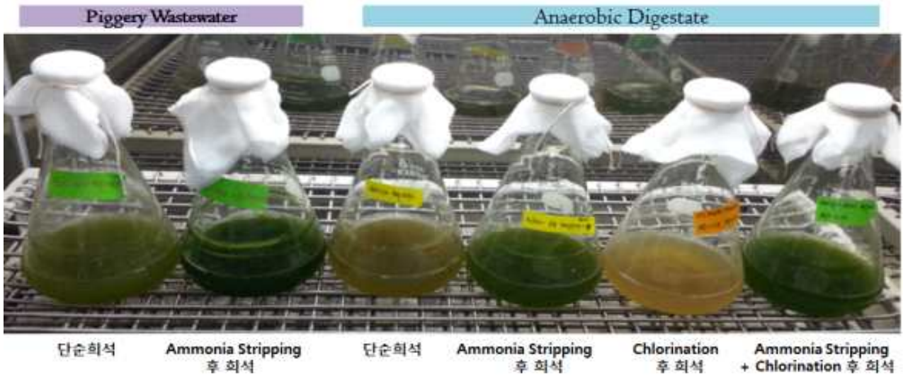
그림 100. 영양염류가 제거된 가축분뇨 및 혐기소화액을 배양배지로 이용한 Chlorella vulgaris 의 성장 사진. 영양염류 제거를 위하여 단순희석 외에 암모니아스트리핑 및 혐소처리 후 희석하여 미세조류의 배양배지로 사용함.
