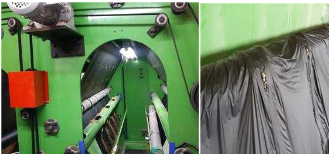
[그림 81] 직파재배용 생분해멀칭 범씨 부착 설비 (G사, 충남 서산)
