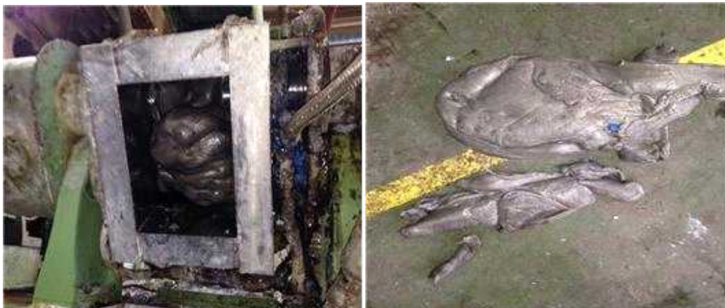
[그림 44] Test 4 (MP2 20w%) 니더 용착 및 냉각 시 고착 현상
