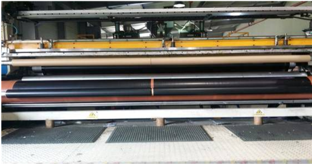
[그림 54] Cast Line 필름 나비 3,000mm 권취 모습
