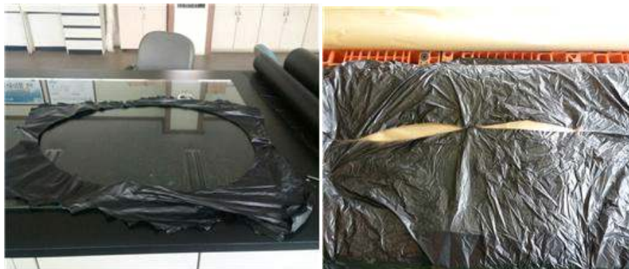
[그림 55] Blown Type & Cast Type 이물 발생 시 현상 (좌: Blown, 우: Cast)
