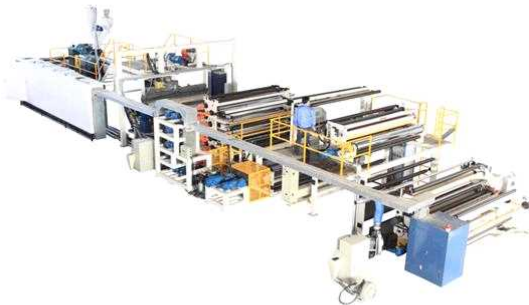
[그림 49] Cast Line Multi-Layer Extruder
