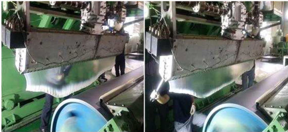
[그림 50] Cast Line Extruder의 PABT 수지 압출 평가(좌: Resin1, 우: Resin2)
