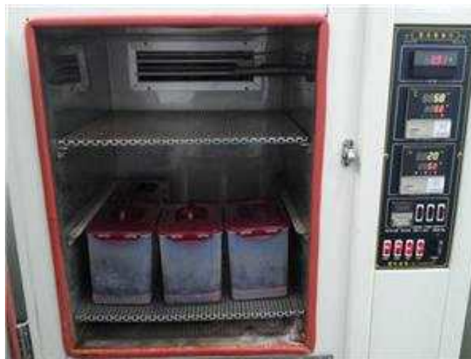
[그림 53] 플라스틱 재료 붕괴도 측정 장치
