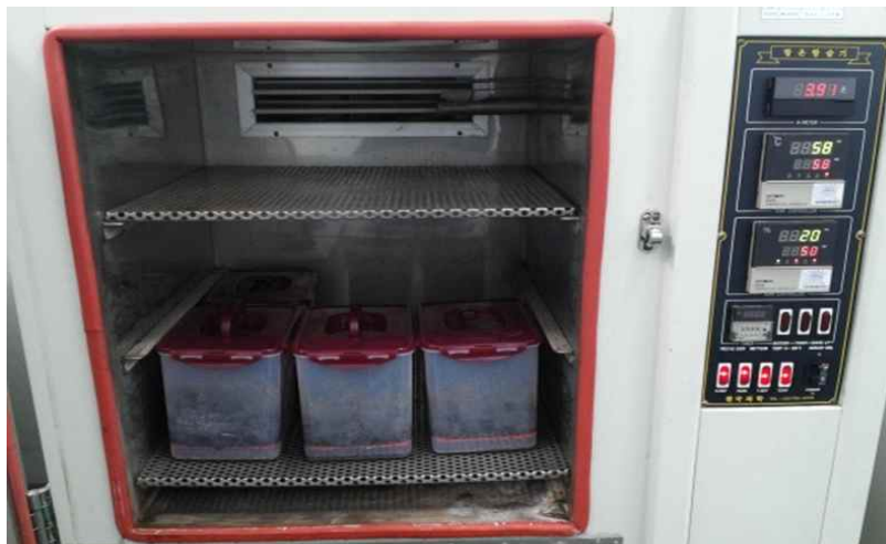
[그림 10] 플라스틱 재료 붕괴도 측정 실험
