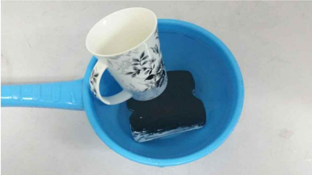
○ 케이스에 공기가 들어있기 때문에 케이스가 물 위에 뜬다. 완벽한 방수 상황을 재현하기 위해서는 물에 완벽히 잠겨야 한다. 위와 같이 케이스 위에 물건을 올려서 완벽히 물에 잠기게 한 후 테스트를 진행한다.
