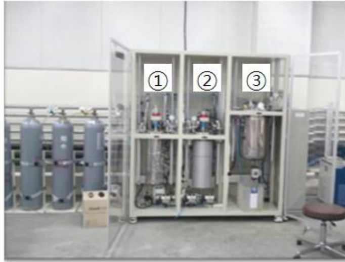
Fig. 3-4-31. 아임계 추출 장치 (R-401 subcritical Extraction Pilot Plant System) (① 예열조, ② 추출기, ③ 수거조).
