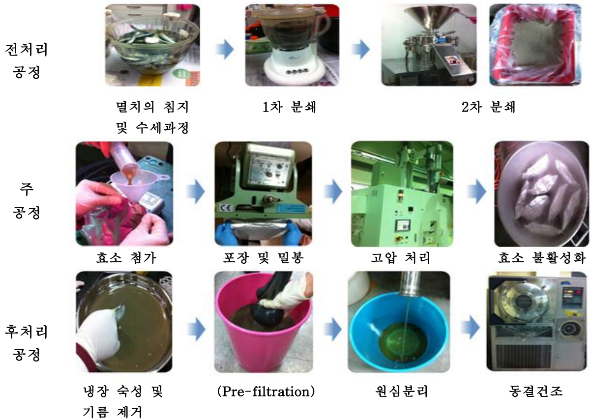
Fig. 3-1-30. 멸치고압효소가수분해물의 Pilot scale 생산 과정
