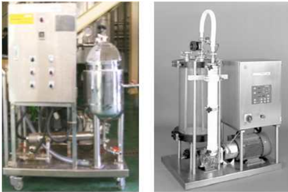
Fig. 3-1-31. 실험에 사용된 한외여과 시스템 (Lab U/F system [10 kDa]과 Proflux M60 Tangential flow filtration system [5 kDa]).
