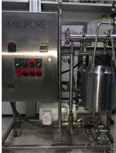
Fig. 3-1-32. 실험에 사용된 나노여과 시스템(Prolab system [250 Da]).
