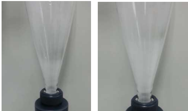
Fig.3-3-6. Blow power에 따른 사이클론 내부 입자의 서로 다른 분포도: 왼쪽: 0.6 \text{ m}^3/\text{min} , 오른쪽: 0.75 \text{ m}^3/\text{min} .
