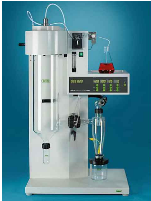
Fig. 3-1-71. 실험에 사용된 분무건조기(mini spray dryer b-290(Buchi, Sweden)).
