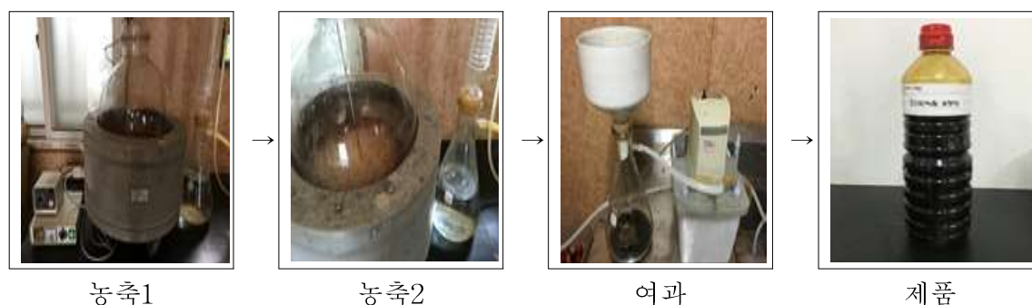
그림 50. 미강효소분해농축액 제조 공정 사진
