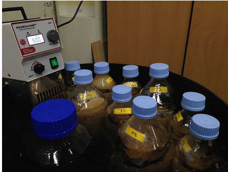
그림 26. 염분농도를 달리한 가수분해 테스트
