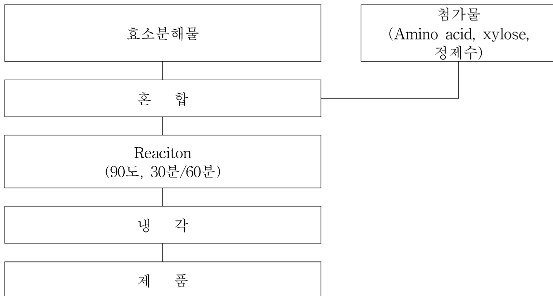
그림 82. Reaction Flavor 제조 공정도
