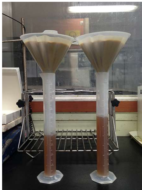
그림 24. Cellulase첨가 유무에 따른 고액분리(여과) 속도
