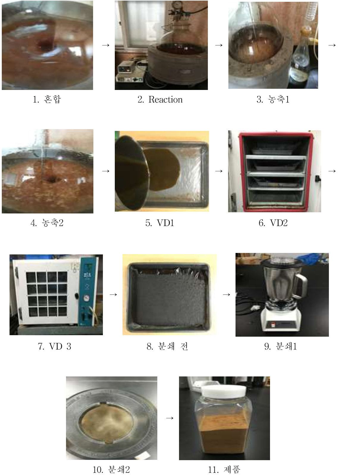
그림 86. Reaction flavor의 제조공정
