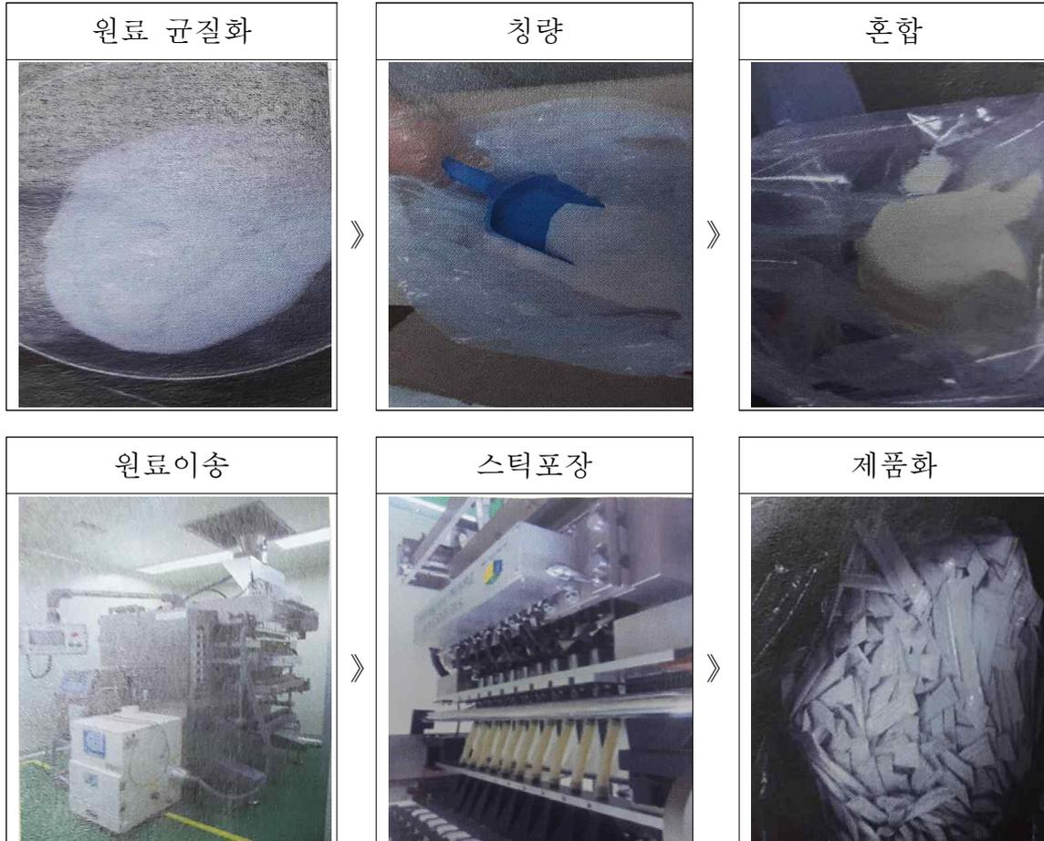
자색고구마 혼합분말의 스틱제품은 건강기능식품GMP 공정에 따라 진행하였다. 먼저 GMP내 공조시스템을 일정시간 선 가동하여 실의 안정화를 수행하고 온도와 습도를 평형화가 진행되고 난 후 작업을 수행하였다. 스틱포장기는 예열을 충분히 하고 가로 실링바와 세로썰링바의 온도를 각700도 이상으로 유지를 시킨다. 상부의 투입구로 원료를 이송하여 흐름을 확인하고 최종 스틱입구로의 흐름성을 최종 확인한다.
