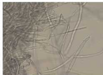
현미경 사진 : 균체 사진. 여액은 현미경에 균사체 및 포자가 보이지 않음(여액은 균체가 매우 적음).
