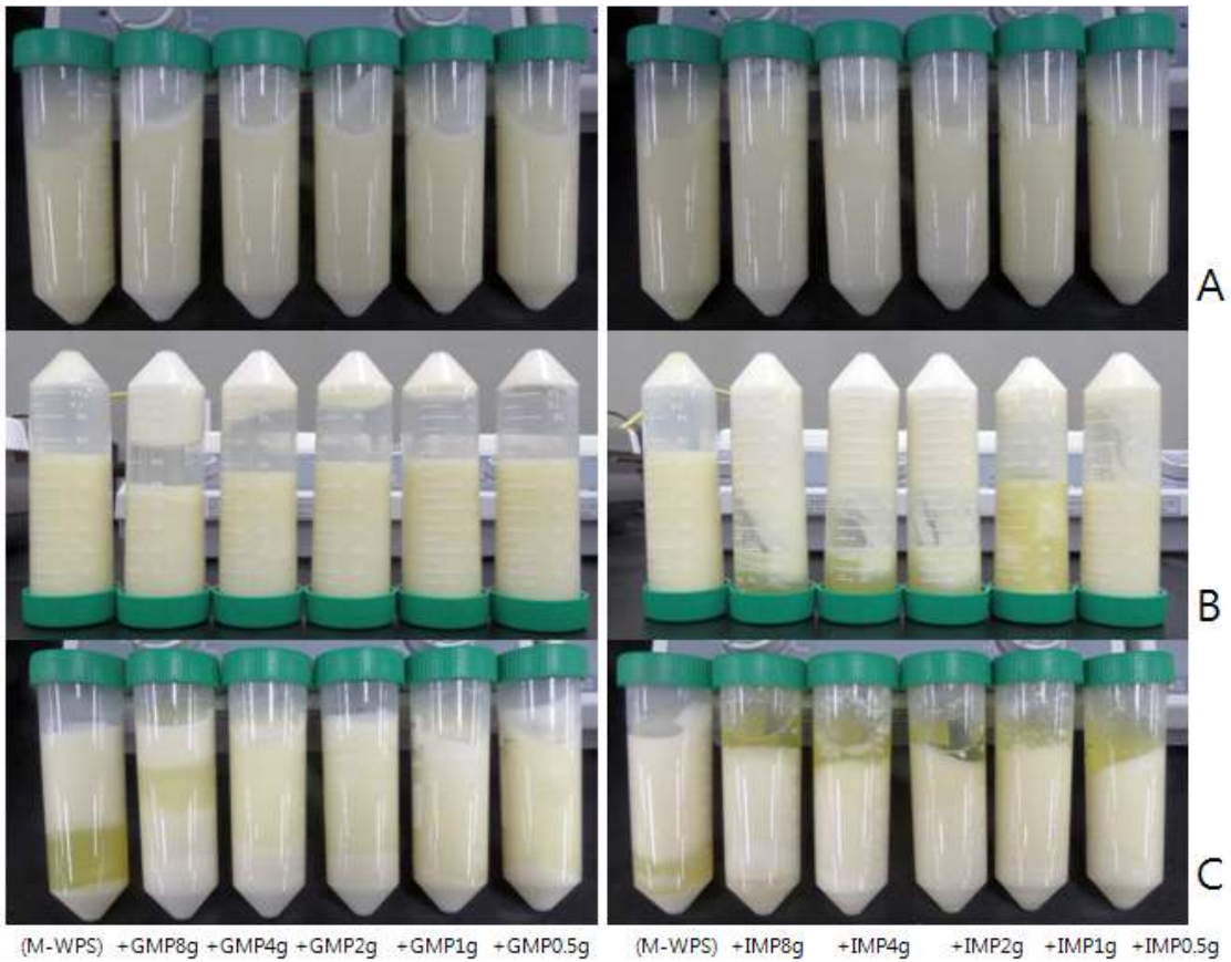
Fig 4. 선제조 Zn-WPS(반응단계까지, 비열처리) 제조후 헥산류 농도별 공정후 열처리(83℃, 20분)시 미네랄 킬레이팅 효과 및 생산수율(침전물 및 상등액 회수) 증대에 미치는 효과 평가
