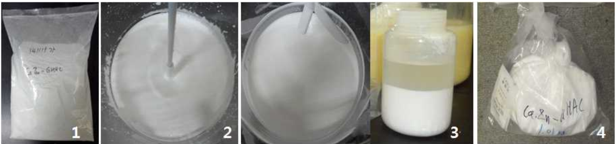
Fig 7 . 기능성 강화 축산물 대량생산시스템 정립을 위해 제조한 현장 유효성 평가용, 이중 핵산 기질화 유기태화 미네랄 소재류(CaZn-GHAC)의 제품 성상 1: 원료배합, 2: 유기태화 반응, 3: 유기태화 반응 3시간 및 UF 진행후, 4: 시제품(FD)
