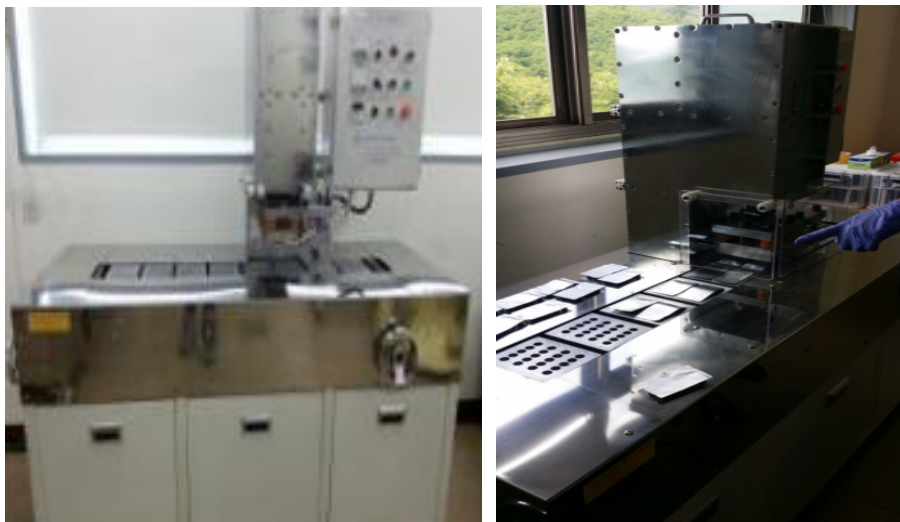
그림 16. 수용성 돈혈 분말 타블렛의 포장에 사용된 PTP 실링기
