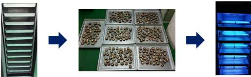
그림. 59. 최적조건하에서의 비타민 D 강화과정
