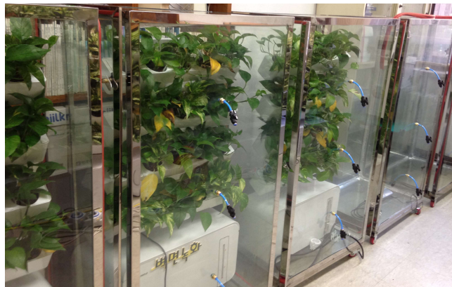
그림 121. 수경 벽면녹화시스템을 이용한 미세먼지 제거 실험 전경
