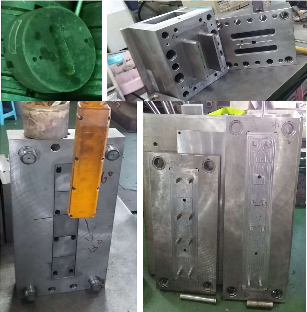
그림60: 프레임저수통 및 화분박스 금형
