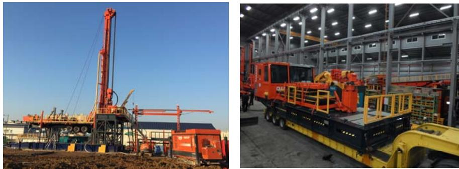
그림 4-1 인양력 450Ton 이상급 장심도 시추기(D&B 450W)
