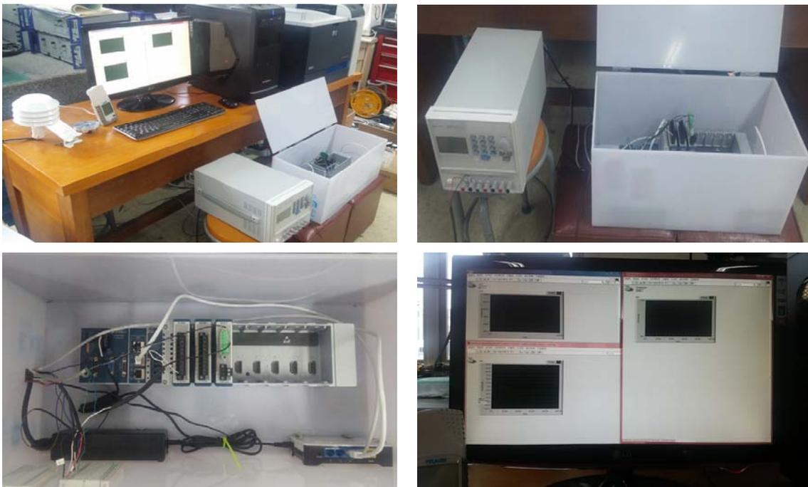
그림 4-13 실험실 내 모니터링 장비 세팅 사진
