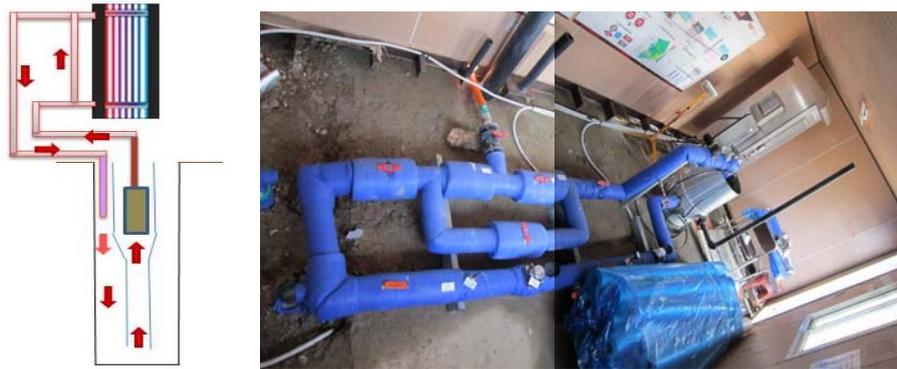
그림 3-124 최고온도 실험 개념도 및 장치 사진
