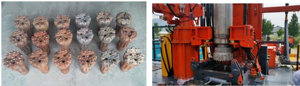
그림 4-2 Water hammer bit (좌:8.5 inch, 우: 12 inch)
