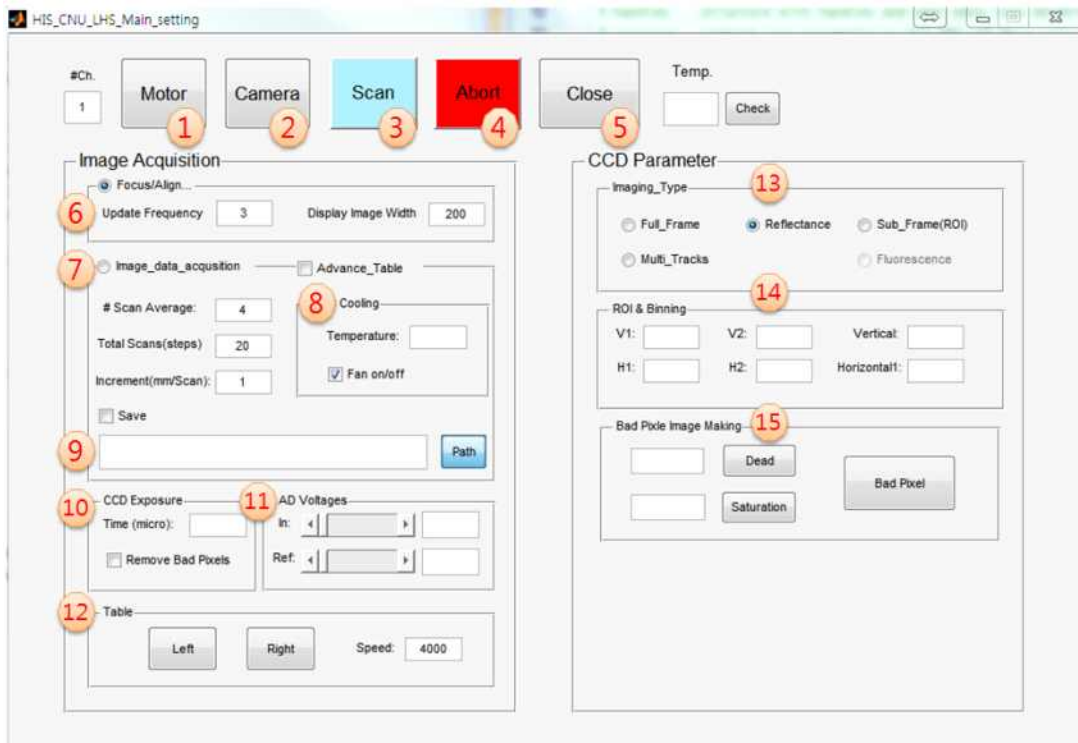
그림 62. Operation program for hyperspectral SWIR imaging system.
