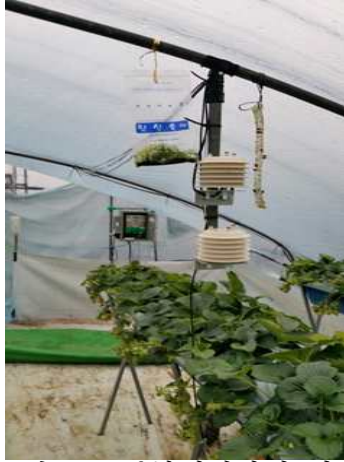
그림 31. 통합제어장치 및 마트센서장치의 딸기재배 농가 설치
