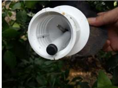
그림 16. 정전용량형 습도센서, 수입센서
