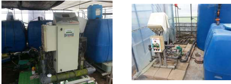
그림 19. 양액제어농가 양액제어기 및 토경재배의 액비혼합기
