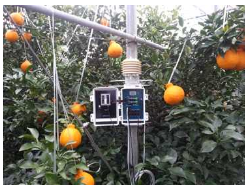
그림 6. 한라봉 재배 하우스 및 감귤노지에 설치된 무선형 데이터 로거
