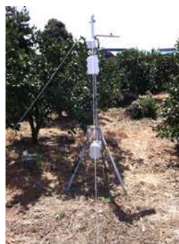
그림 6. 한라봉 재배 하우스 및 감귤노지에 설치된 무선형 데이터 로거
