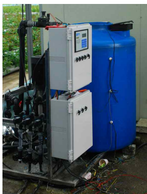
그림 3. 이스라엘 네타핌사의 양액제어장치 및 스마트형 온실제어장치
