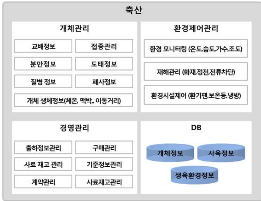
[그림 6-14] 스마트 농업(스마트 축산) 시스템 구성도
