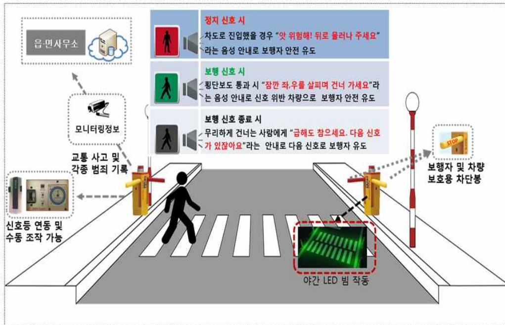
[그림 6-57] 보행자안전통합시스템 표준모델 서비스 시나리오
