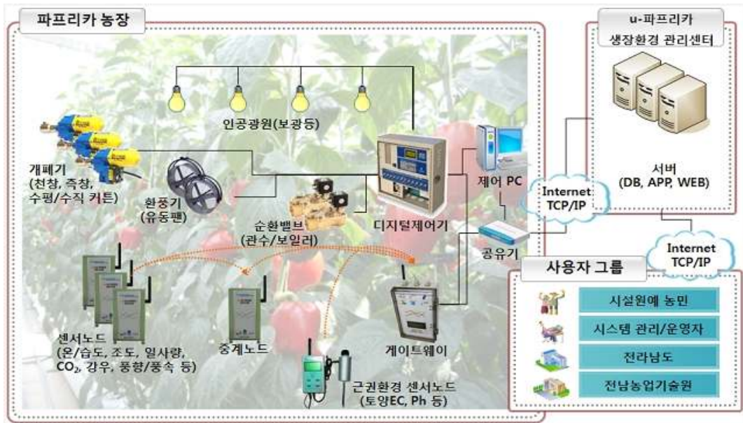
[그림 3-26] Green u-IT를 활용한 수출 파프리카 성장환경관리 시스템
