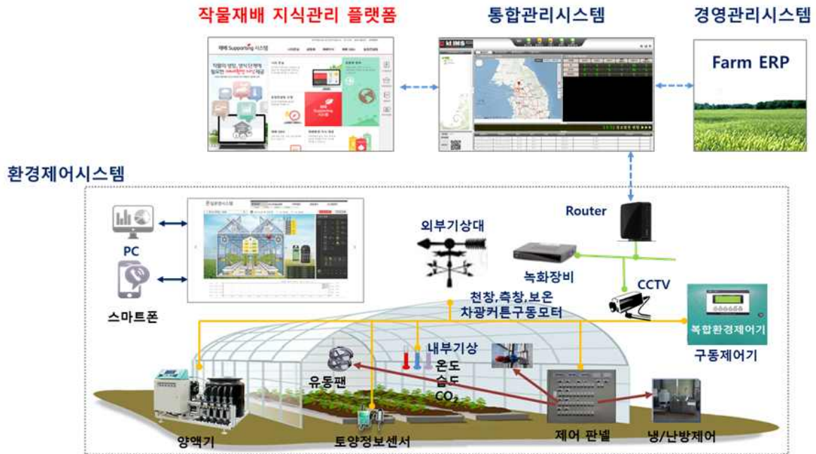
[그림 6-9] 스마트 농업(스마트 시설원예) 시스템 개념도
