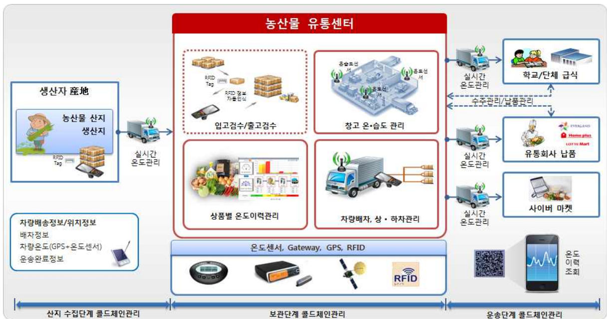
[그림 6-36] 콜드체인 시스템 개념도 및 시나리오
