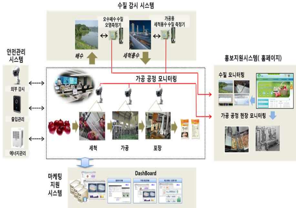
[그림 6-20] 스마트 농산업(스마트 가공) 시스템 구성도
