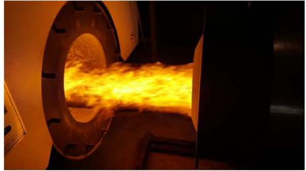
<그림 3.46> 가금류 사체처리 절차(4) 액상생성물 연소 및 최종처리
