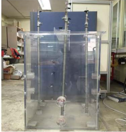
<그림 3.31> 열가수분해 상온 실험장치 (좌: 실험장치 전체, 우: 수직 스파지 파이프)
