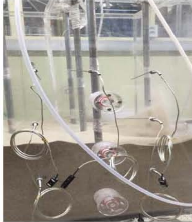
<그림 3.32> 중앙 및 측면 수직 스파지 파이프 설치
