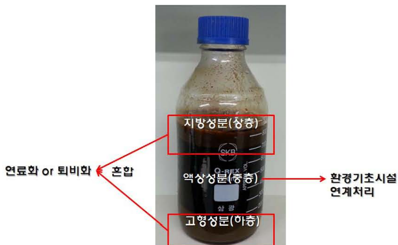
<그림 3.20> 열가수분해 반응물 성상 및 처리, 활용방안
