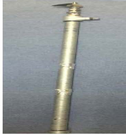
<그림 3.31> 열가수분해 상온 실험장치 (좌: 실험장치 전체, 우: 수직 스파지 파이프)
