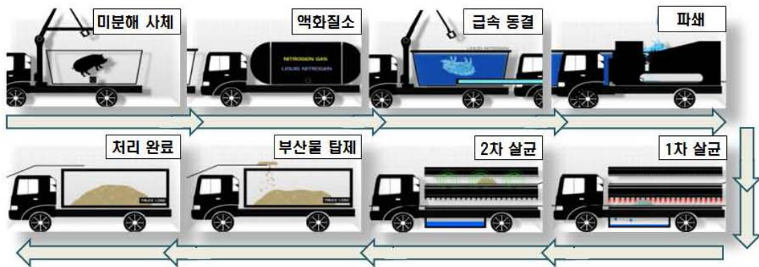
<그림 2.4> 냉동건조 공법을 이용한 가축사체 처리과정
