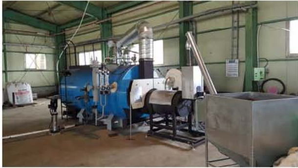
<그림 3.46> 가금류 사체처리 절차(4) 액상생성물 연소 및 최종처리
