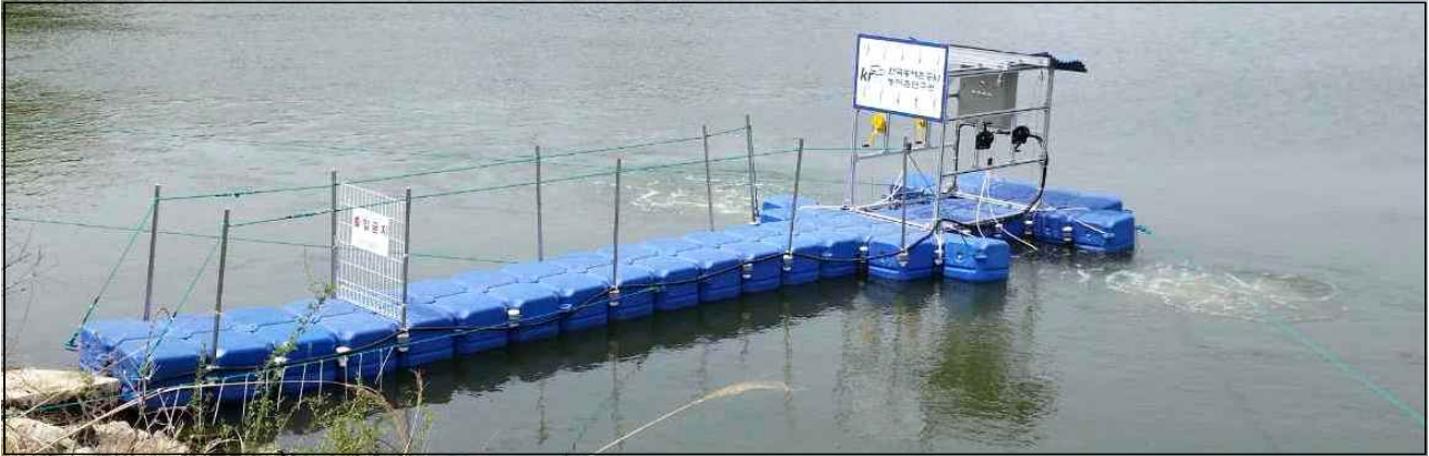
<그림 5-19> 교반폭기장치 설치(예시도)
