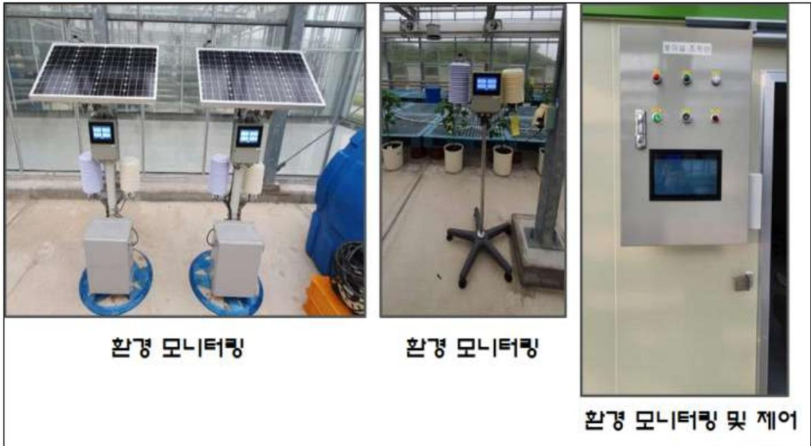
그림. 환경 모니터링 및 제어 장치
