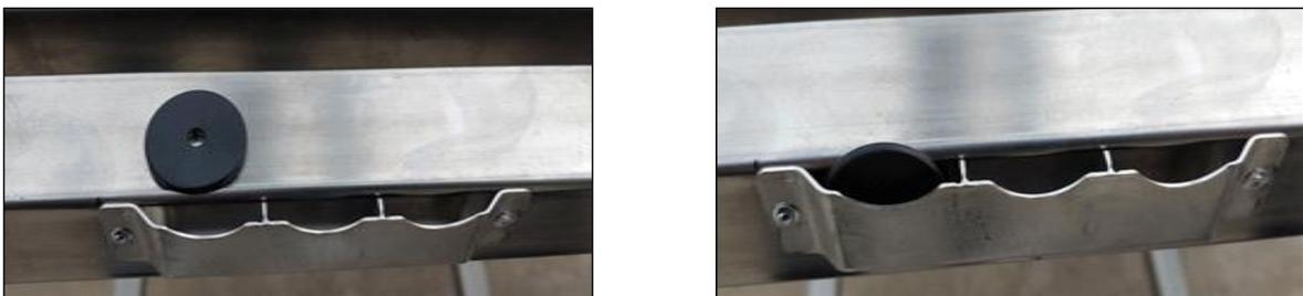
그림. 스마트 대차 부착된 RFID 칩
