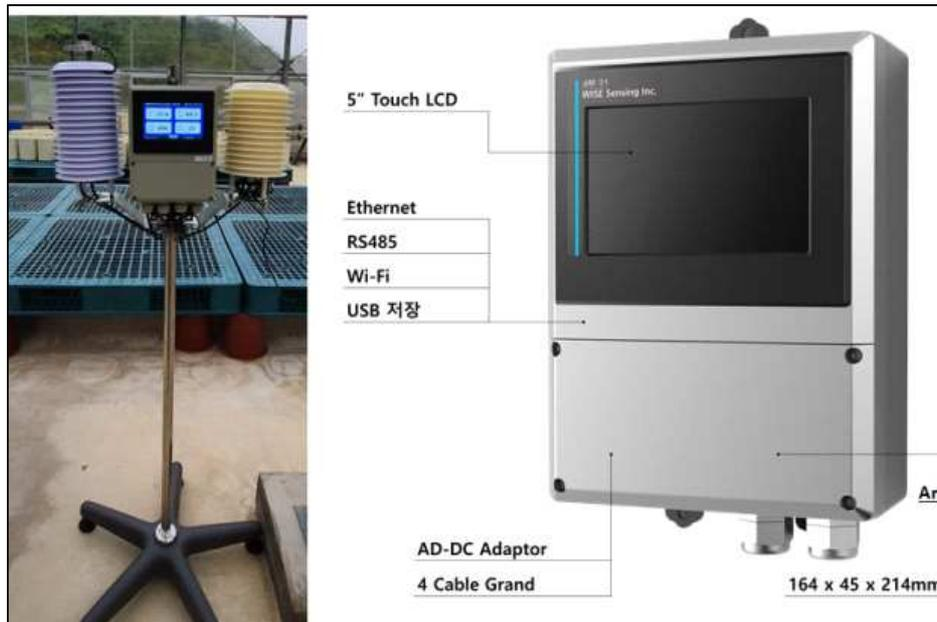
그림. 환경 모니터링 장치
