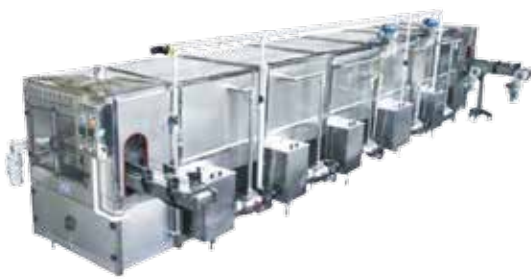
【그림 6-9】 터널살균기(Tunnel pasteurizer)의 외부(좌)와 내부(우)
