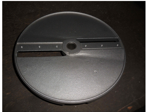
쇼트 작업 후
